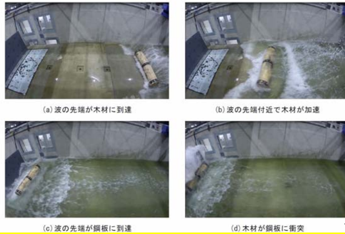
図-18 実験における木材の漂流時挙動 (横向き, 初期水深 0mm)
