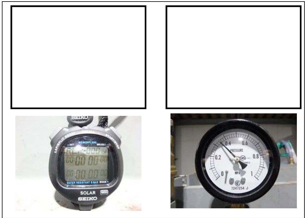
図 5.14.2.2-24 0.35 MPa 加圧開始
