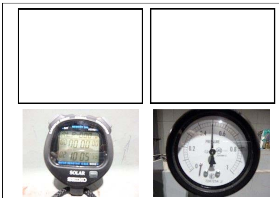
図 5.14.2.2-19 0.50 MPa 10 分経過後(漏えい無し)
