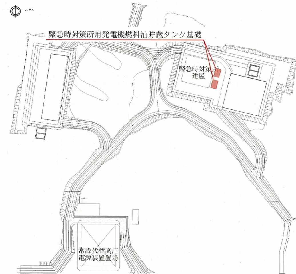
図 1. 4. 17-1 緊急時対策所用発電機燃料油貯蔵タンク基礎の平面配置図
