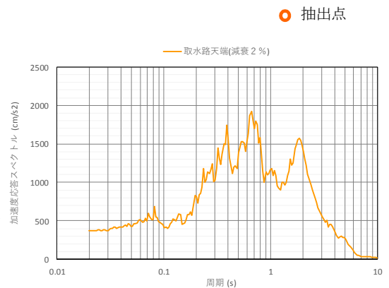
図9 既設取水路の二次元有効応力解析による応答時刻歴と応答スペクトル(堤軸方向)
