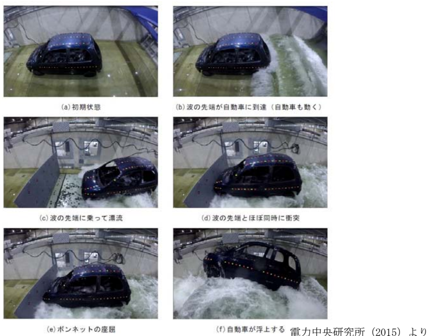
図-3 車両の水流中衝突実験状況
