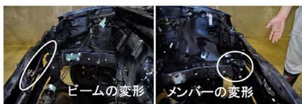
図-5 車両の残留変形の様子 高島ほか (2015) より
