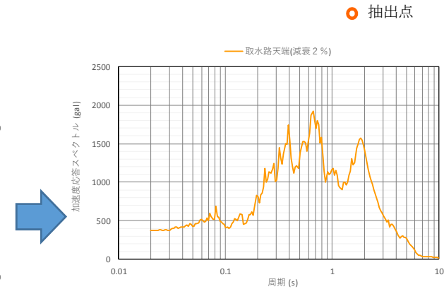
図9 既設取水路の二次元有効応力解析による応答時刻歴と応答スペクトル(堤軸方向)
