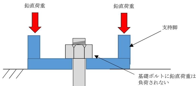
図 3 基礎ボルト部拡大図
