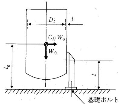
図5 4脚支持たて置き円筒型容器
