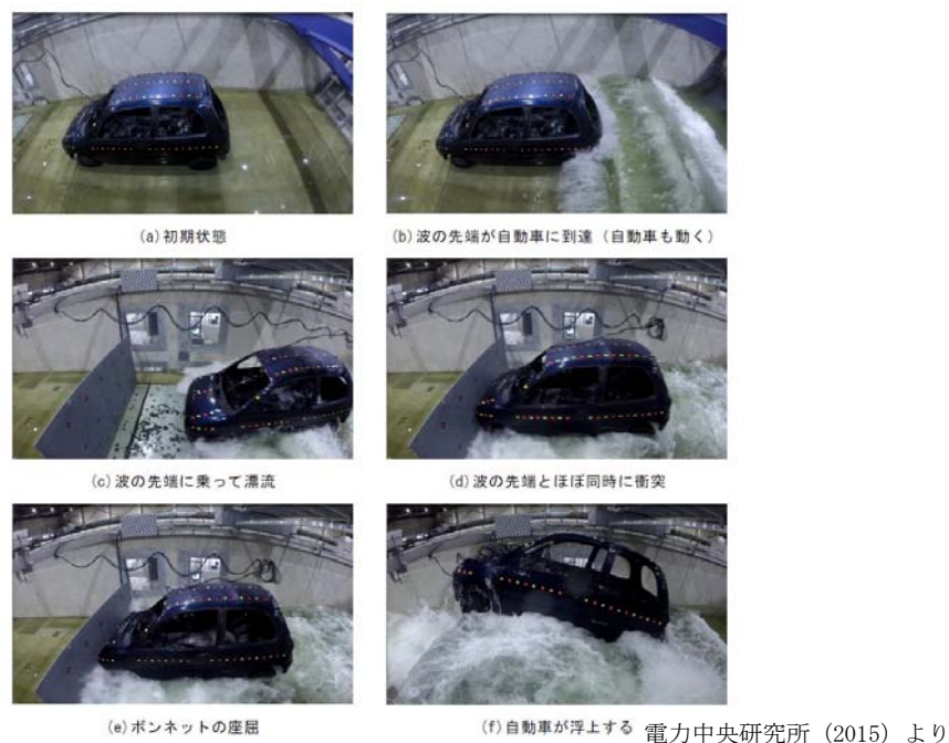
図-1 車両の水流中衝突実験状況
