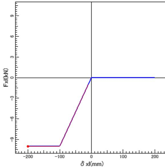
第3.5-10図 バネの応答履歴
