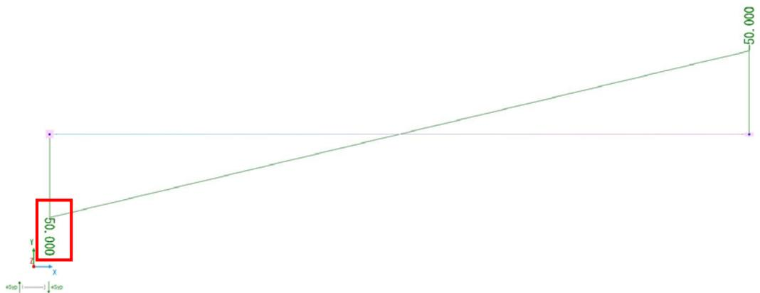
最大せん断力  $S_{y p m a x} = 50 \text{ kN}$
