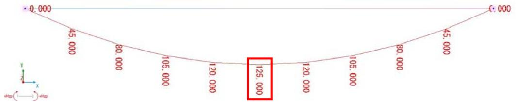
第3.5-2図 曲げモーメントの算出結果
