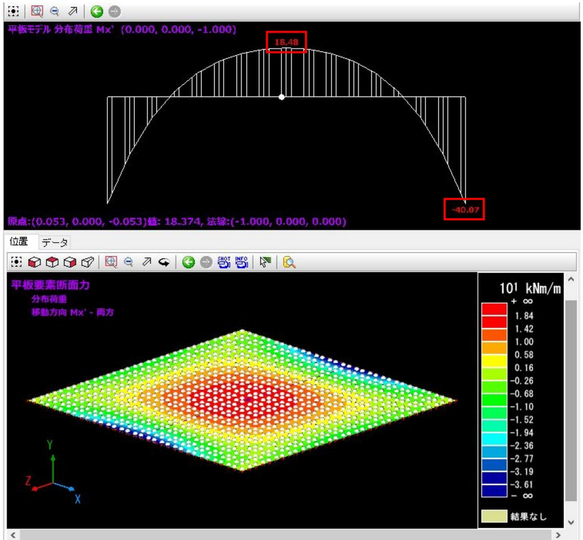
第3.5-6図 曲げモーメントの算出結果
