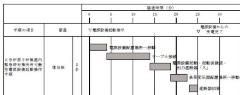
第 1.18.27 図 5号炉原子炉建屋内緊急時対策所用可搬型電源設備 起動操作手順タイムチャート
