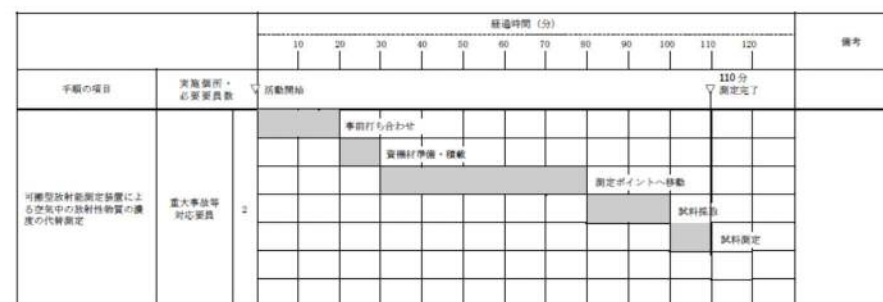
第 1.17-6 図 可搬型放射線測定装置による空気中の放射性物質の濃度の 代替測定のタイムチャート
