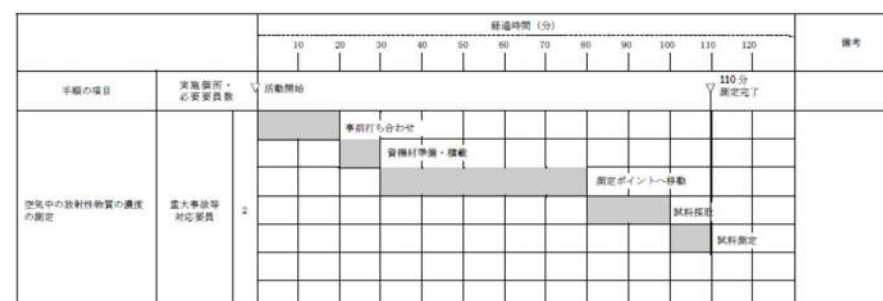
第 1.17-7 図 可搬型放射線測定装置による空気中の放射性物質の濃度の測定 のタイムチャート
