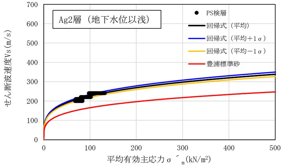
図 1.1-2 (3)  $V_s$  の  $\sigma'_m$  依存式 (Ag2 層 (地下水位以浅))
