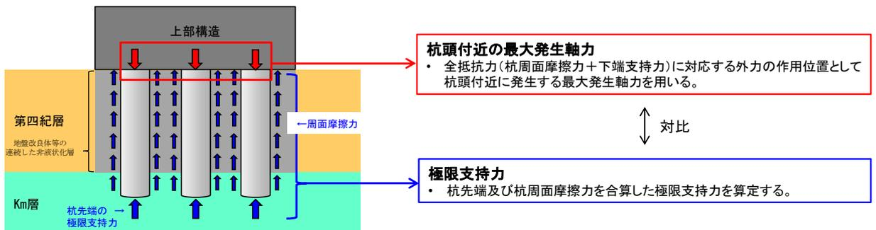
図2 杭周面摩擦力を支持力として考慮する評価の適用イメージ
