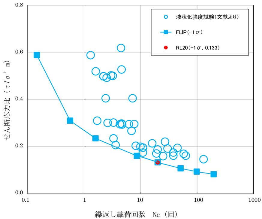
図 4.2-11 FLIPによる豊浦標準砂の液状化強度特性 (-1σ)
