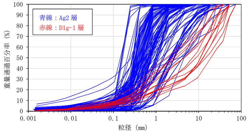
図 3 D1g-1 層と Ag2 層の粒度分布の比較
