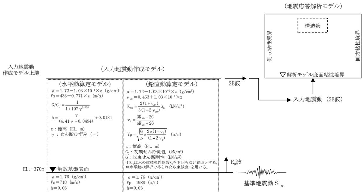
図 6.1-1 入力地震動算定の概念図
