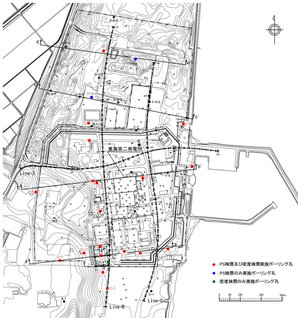
図 6.3-2 PS 検層実施位置図（敷地の地質・地質構造検討用）
