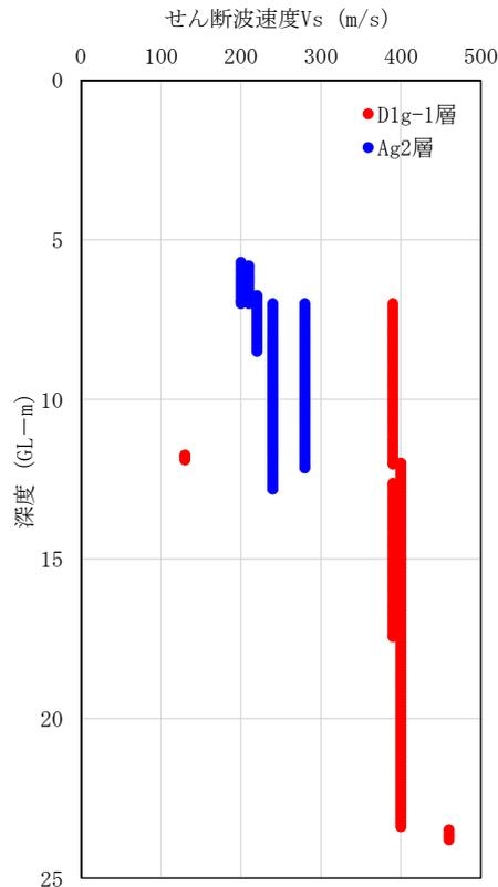
図 4 D1g-1 層と Ag2 層の PS 検層の比較
