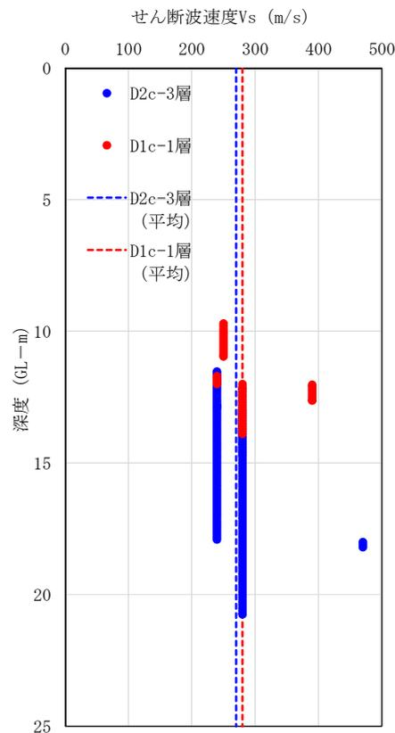
図 6 D1c-1 層と D2c-3 層の PS 検層の比較
