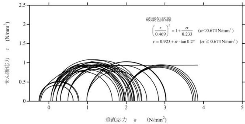
注：土被り圧相当で圧密した後、所定の側圧のもとで実施した非排水三軸圧縮(CUU)試験
