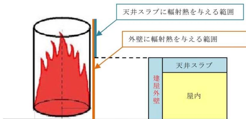
図 2.1.1-4 天井スラブの評価概念図
