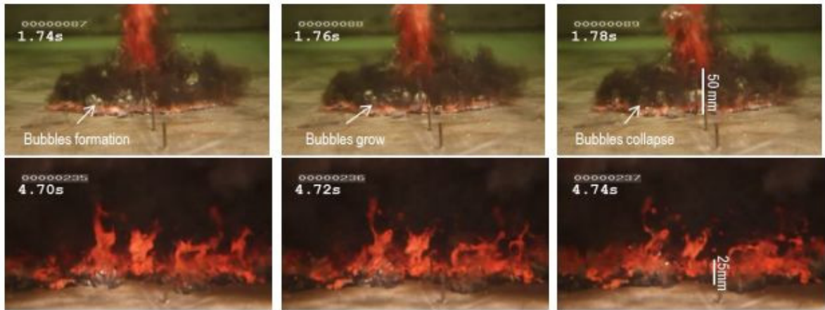
付図 4-8 PULiMS 実験 E4 ケースの溶融物拡がり挙動のスナップ写真 [21]
