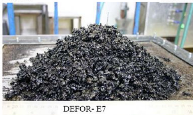
付図 3-6 DEFOR-E 実験後のデブリ状態 [16]
