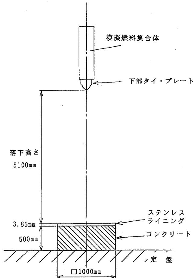
図1 模擬燃料集合体落下試験方法
