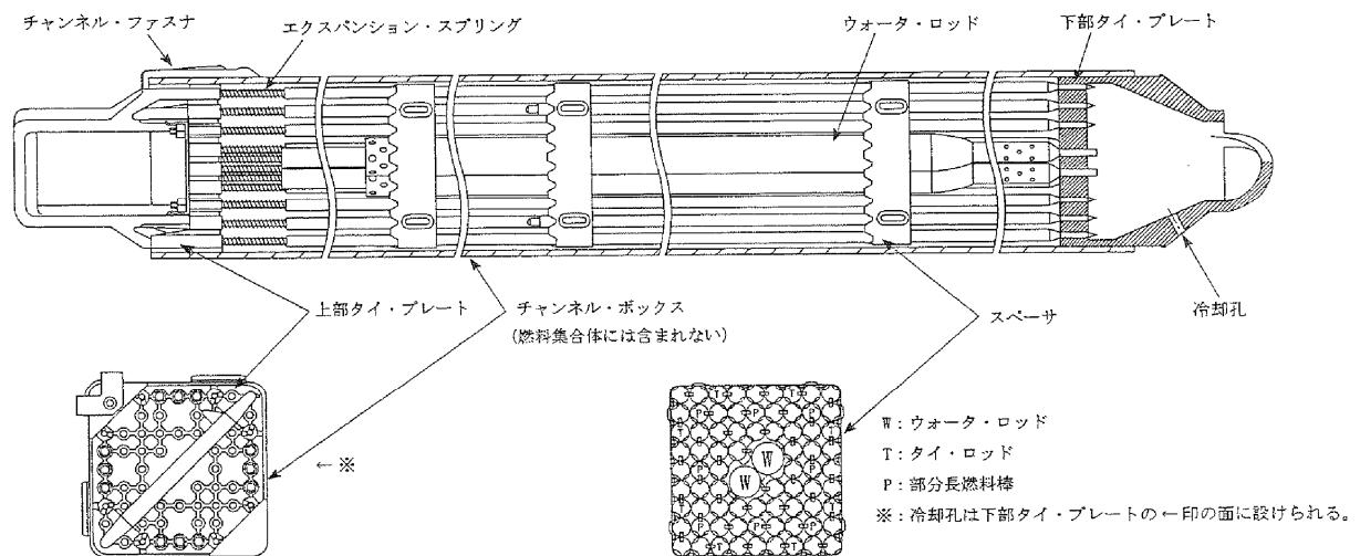
第 13.1 図 燃料集合体の概要 (9 × 9 燃料 (A型))
