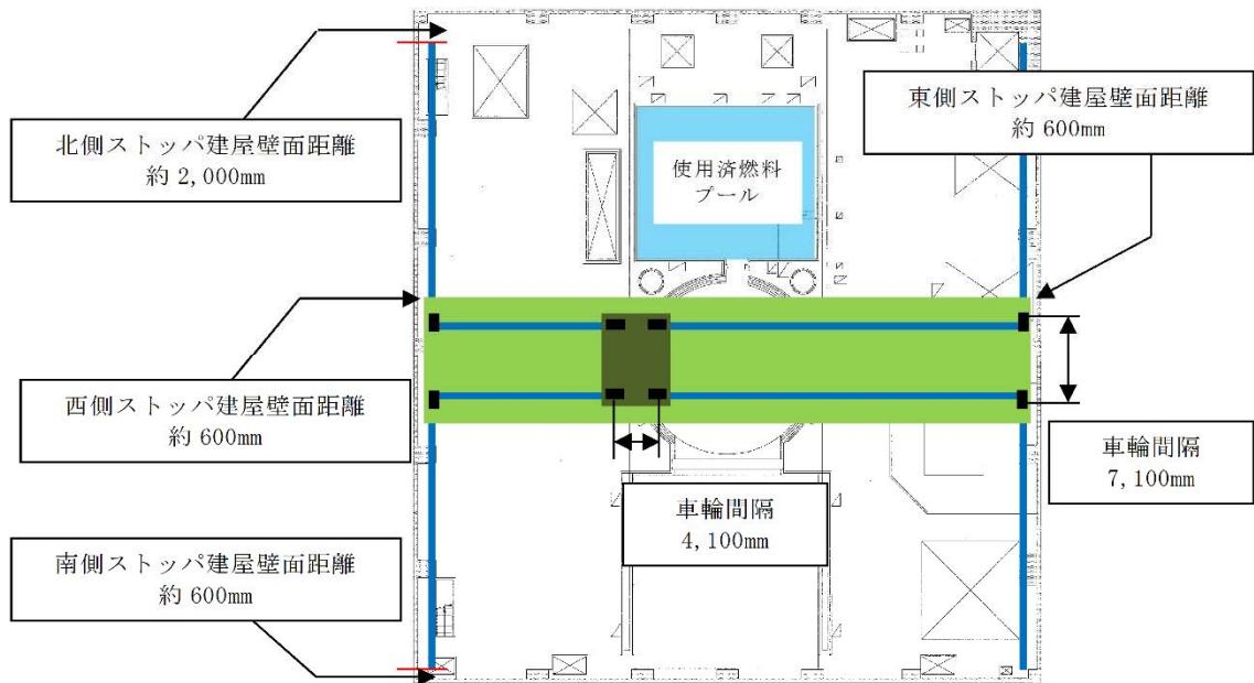
第12図 原子炉建屋クレーンと使用済燃料プールの位置関係
