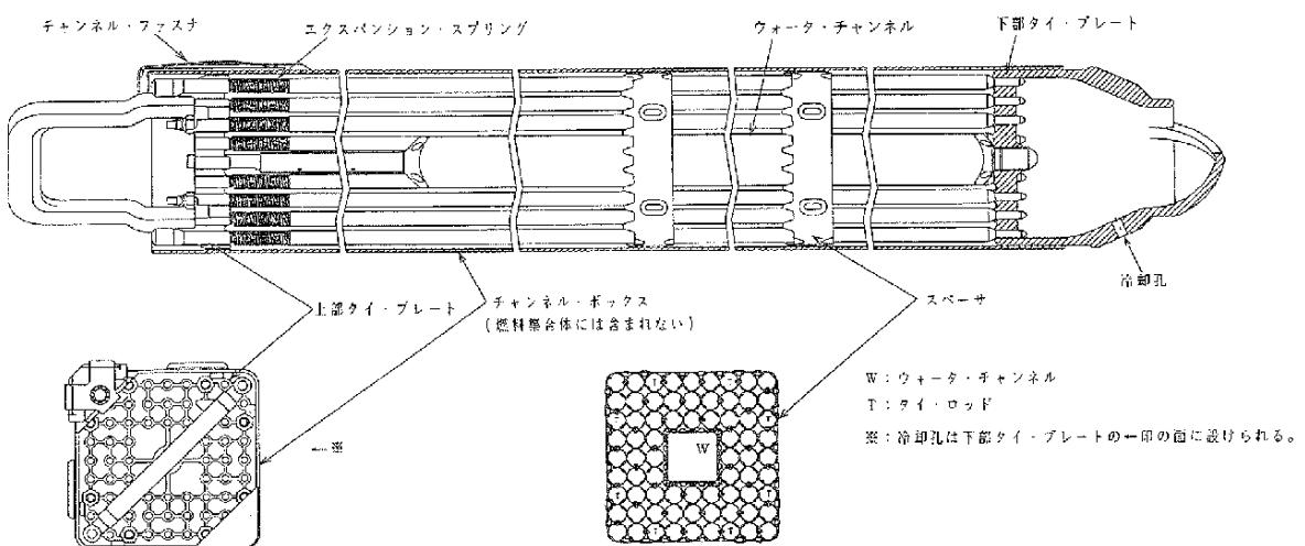
第 13.2 図 燃料集合体の概要 (9 × 9 燃料 (B型))
