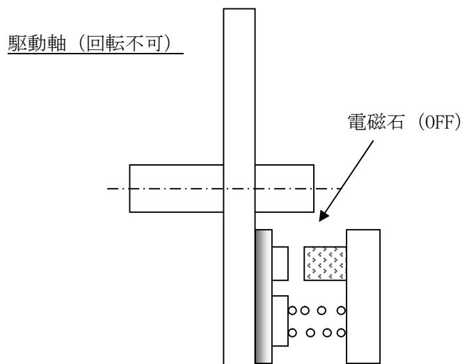
第2図 電磁ブレーキの動作原理
