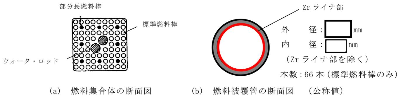
第 17 図 燃料集合体の断面図
