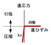
図 6.13.3-11 杭下端ジョイントばね設定の考え方
