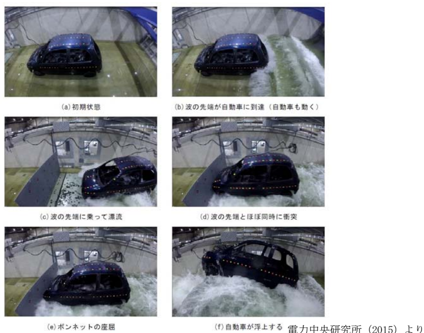
図-1 車両の水流中衝突実験状況
