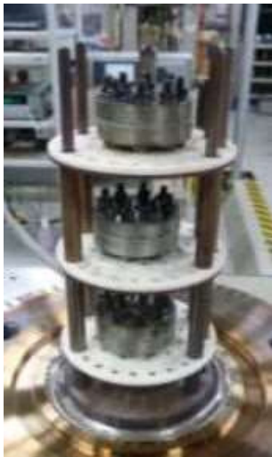
第4図 蒸気曝露 試験片設置状況
