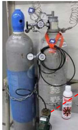
第5図 気密確認試験状況
