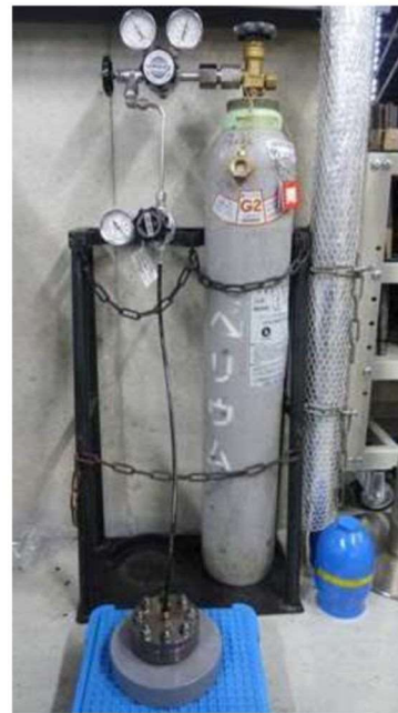
第 13 図 H e 気密確認試験状況
