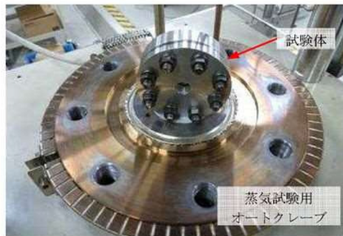
第4図 蒸気曝露試験体設置状況
