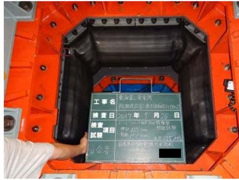
図 5.14.1.2-31 試験 No. ⑥ 加圧状況 (0.55MPa)
