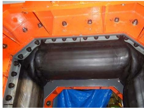
図 5.14.1.2-23 試験 No. ⑤ 加圧状況 (0.55 MPa)
