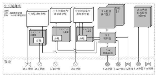
図1-1-2-1-1 重大事故時における中央制御室の監視操作設備の構成概略
