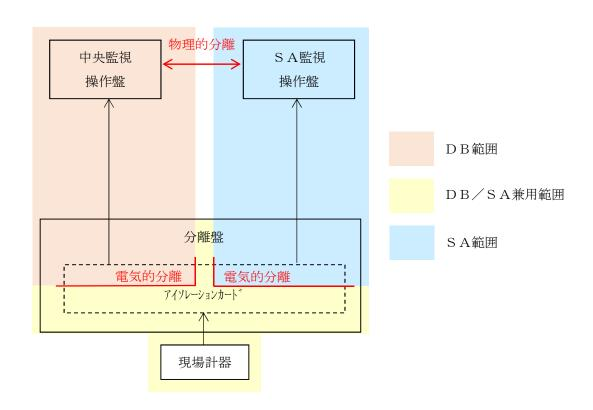
図 2-4-1-1 中央監視制御盤に関する分離設計の概念図
