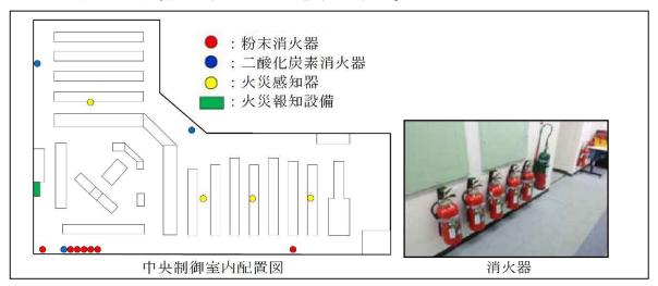
第1.3-2図 中央制御室の火災防護措置
