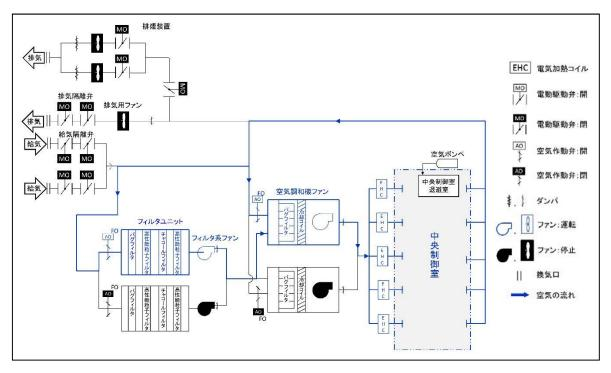
第1.3-5図 中央制御室換気系の概要図 (閉回路循環運転時)
