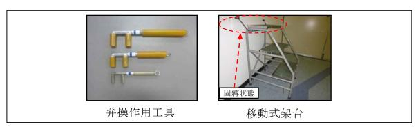
第2.2-6図 弁操作用工具及び移動式架台(例)
