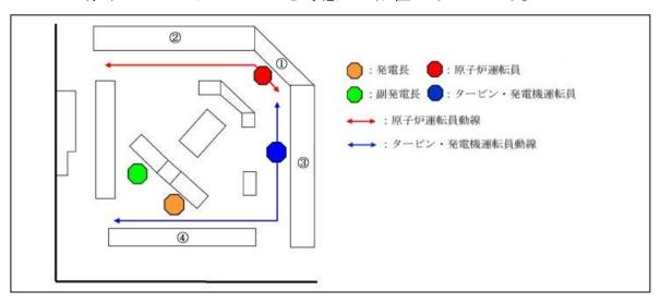
第2.1-2図 主制御盤の配置及び運転員の動線
