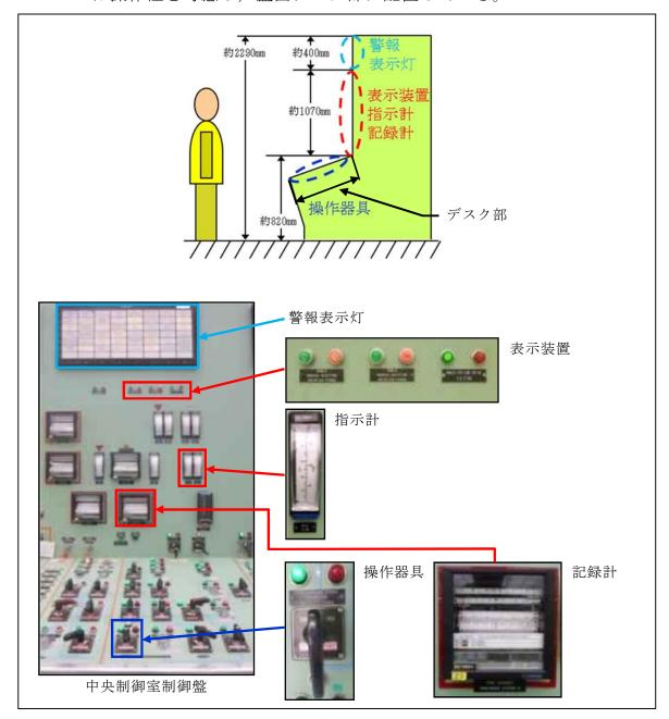
第2.1-9図 制御盤の盤面配置
