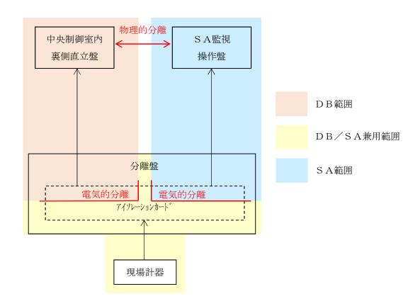
図 2-4-1-2 中央制御室内裏側直立盤に関する分離設計の概念図 (例1)
