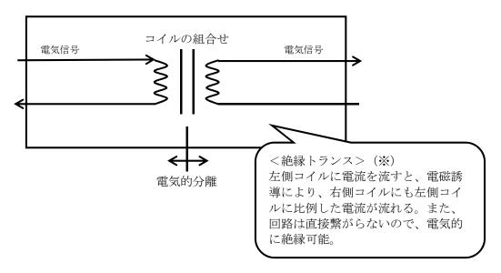
図 2-4-1-4 アイソレーションカードの概念図
