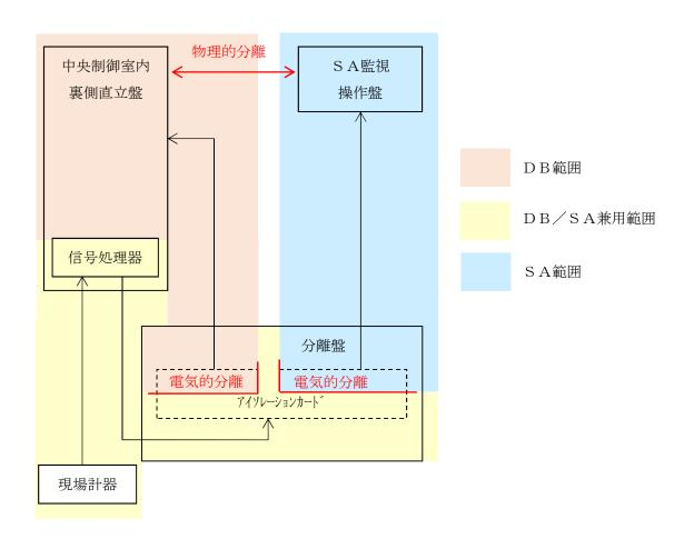
図 2-4-1-3 中央制御室内裏側直立盤に関する分離設計の概念図 (例 2)
