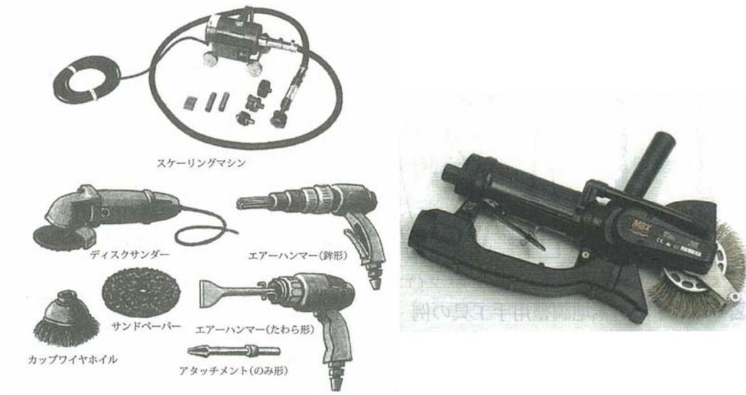
図 5.13.2.3-14 素地調整用動力工具の例
