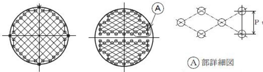
図2-5 管板の計算に用いる多角形
