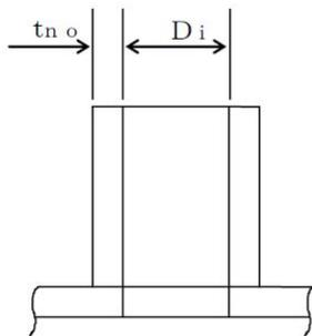
本図は、管台の内径及び呼び厚さの寸法を説明するものであり、管台の取付け形式を示すものではない。
