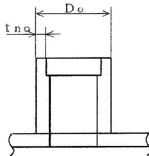
本図は、管台の外径及び呼び厚さの寸法を説明するものであり、管台の取付け形式を示すものではない。
