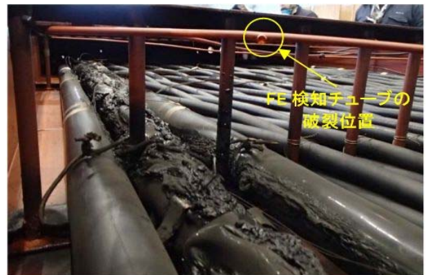
第 11 図 試験 V2 発火・消火・試験後の状態
