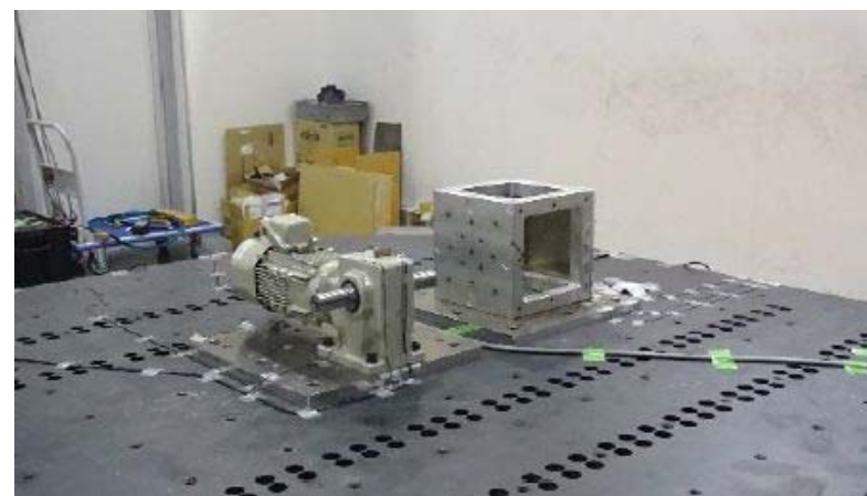
第2図 電動機等加振試験
