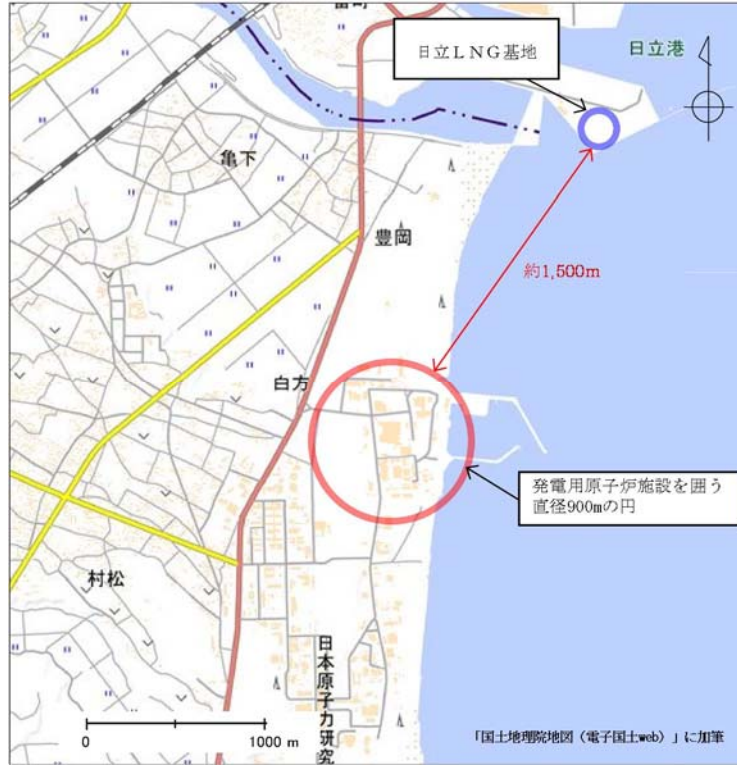
図 2-9 発電所周辺（東海村全域及び日立市の一部）に存在する第四類危険物貯蔵施設
