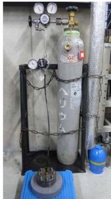
図 13 He 気密確認試験状況
