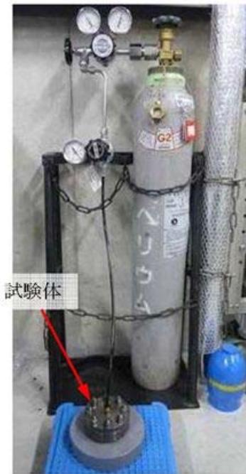
図5 He気密確認試験状況
