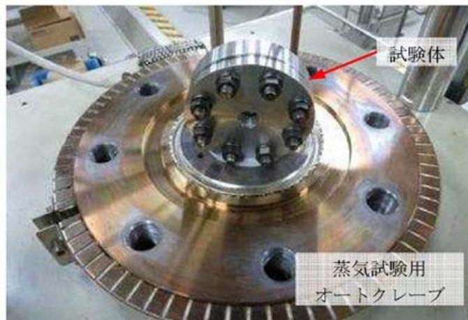
図4 蒸気曝露試験体設置状況
