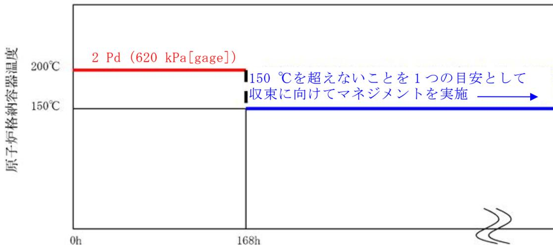
図6 格納容器温度の168時間以降の考え方
