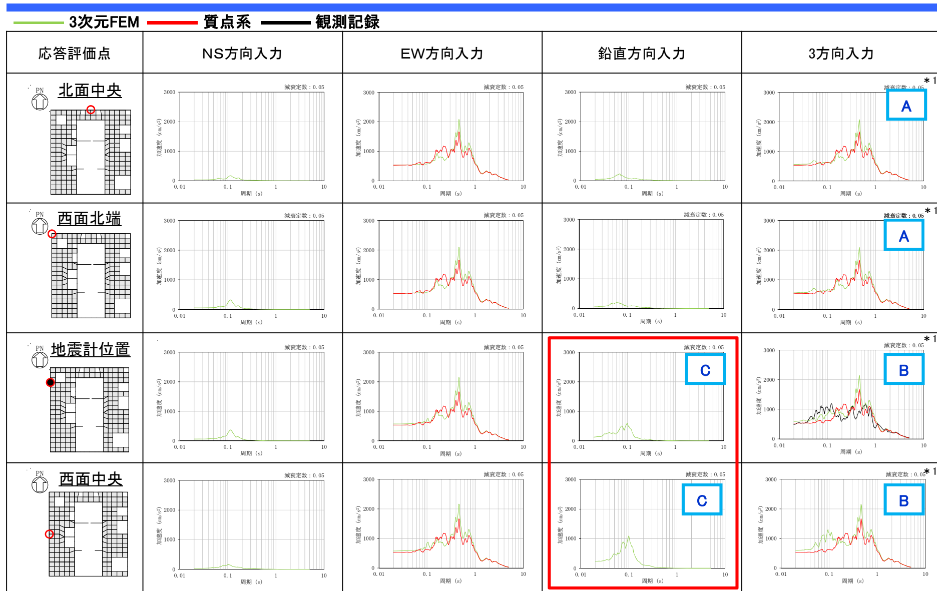
図9 地震動入力方向の違いによるEL46.5mのEW方向床応答スペクトルの比較
