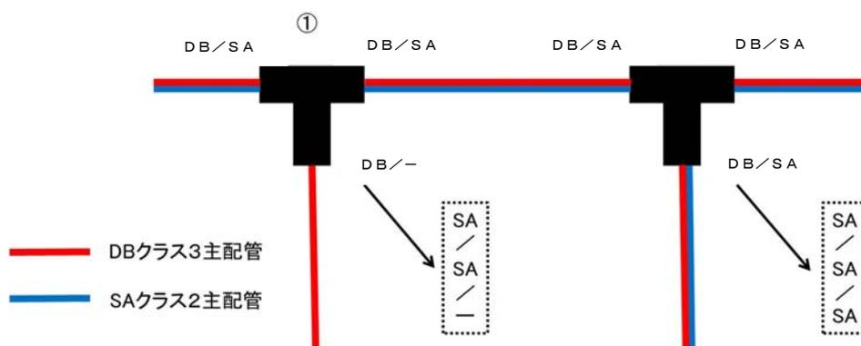
②既設の設計基準対象施設のクラス2配管の管継手に関しては、既工事計画書に記載されていないもので新規制においても主配管に該当する場合は、記載の適正化として「変更前」に管継手を追記し、その旨を注記で記載する。
