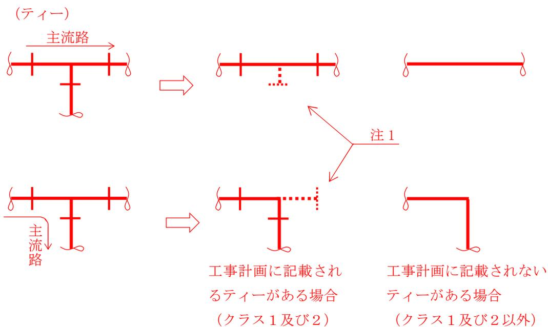
注1 : 工事計画に記載の管継手であり、主流路でない部分は破線(細線)とする。
