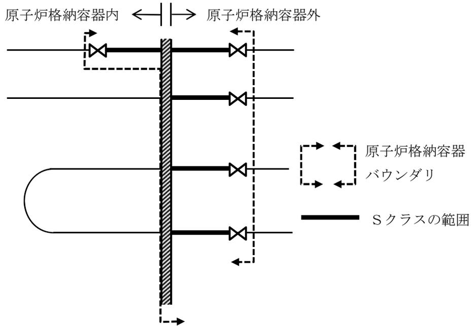
図3-1 原子炉格納容器バウンダリとSクラスの範囲
