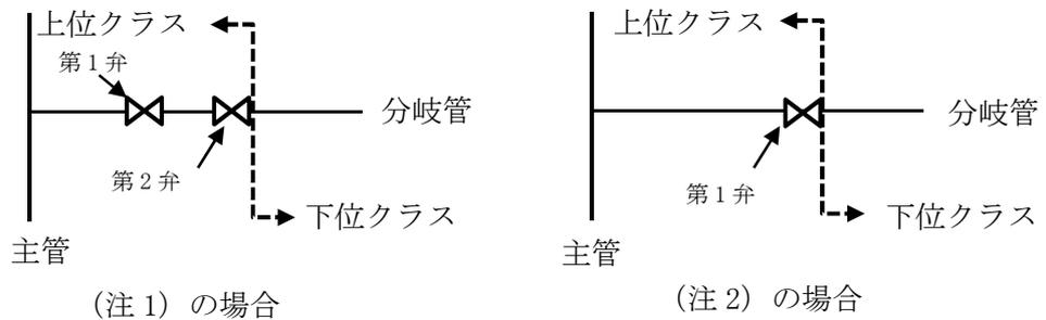
図3-2 配管系中の取合点
