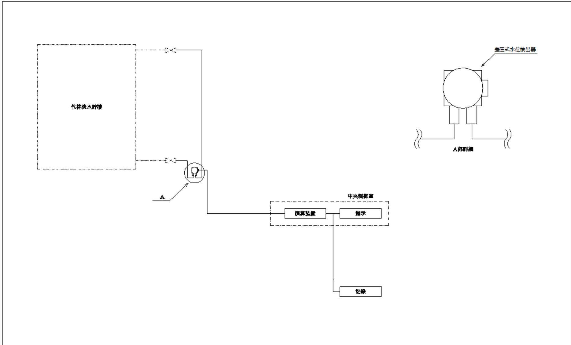
図 3-1-5-2 検出器の構造図 (代替淡水貯槽水位)
