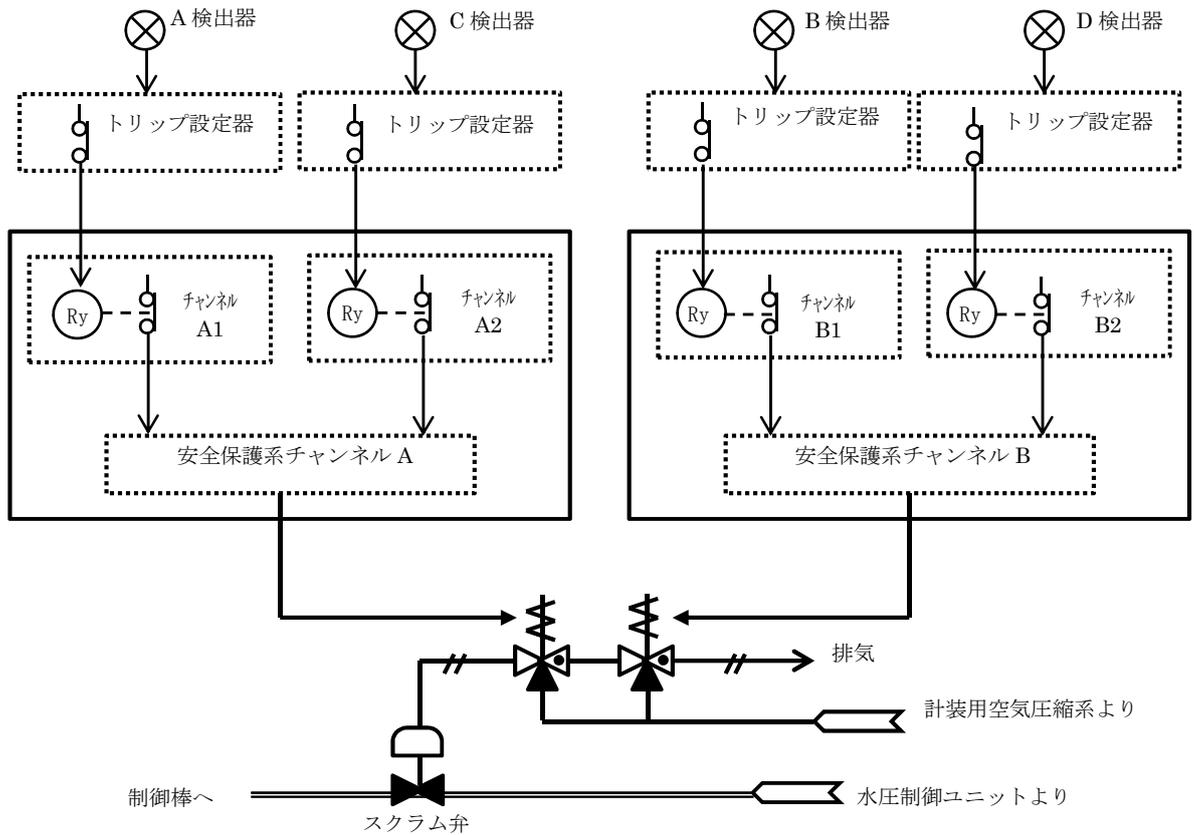
図 3-3-1 原子炉緊急停止系の構成例
