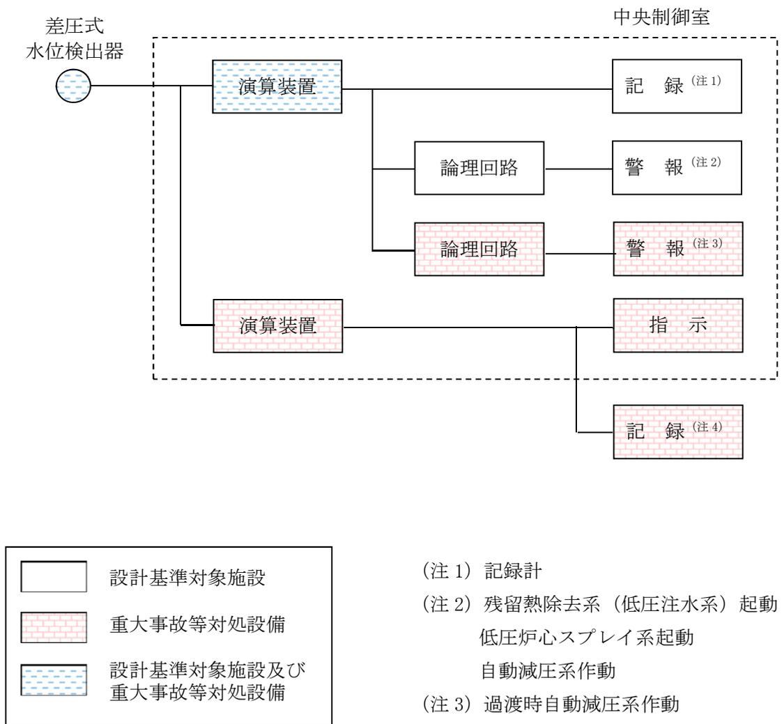
図 3-1-3-5 原子炉水位（広帯域）の概略構成図
