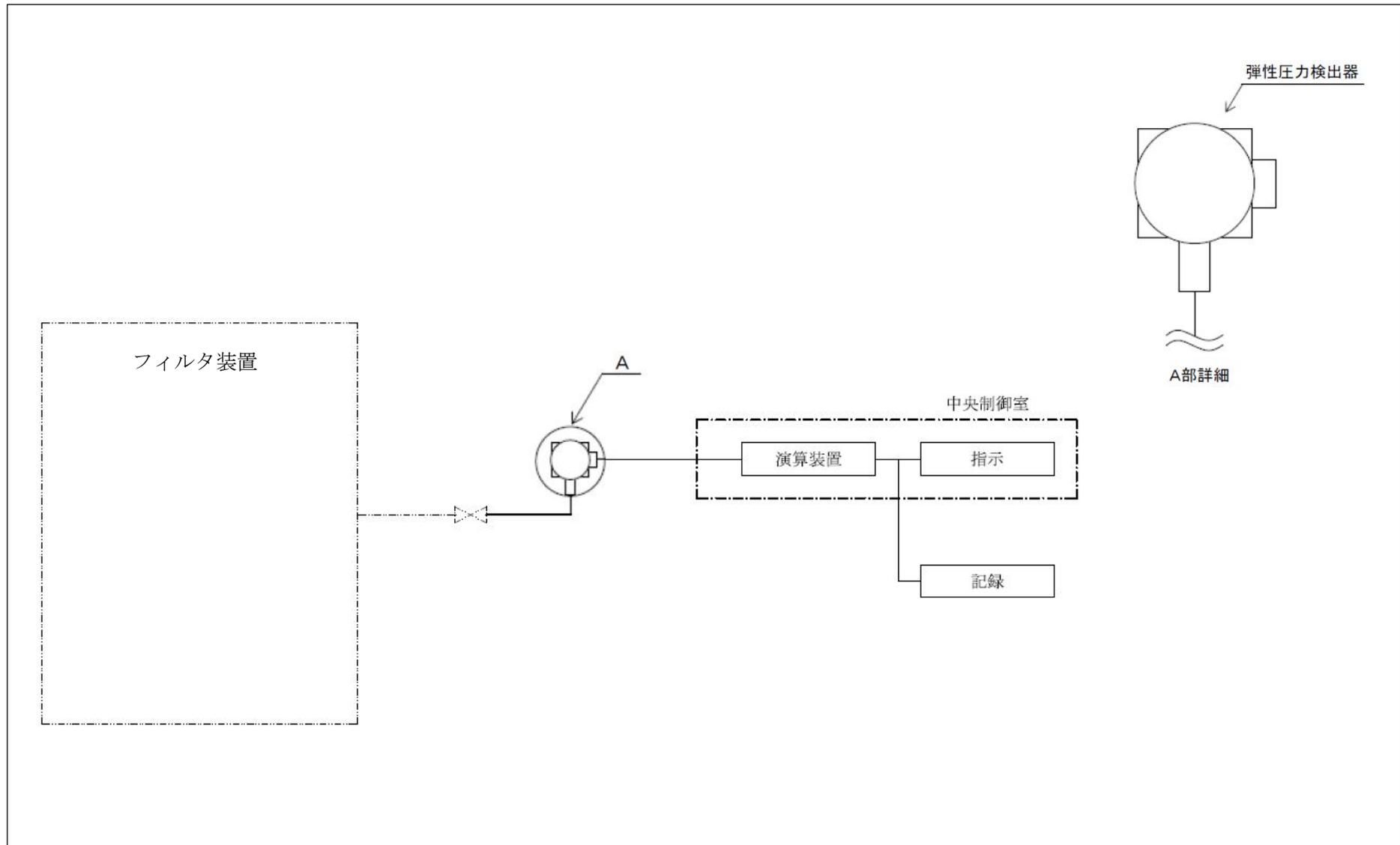
図 3-1-9-6 検出器の構造図 (フィルタ装置圧力)
