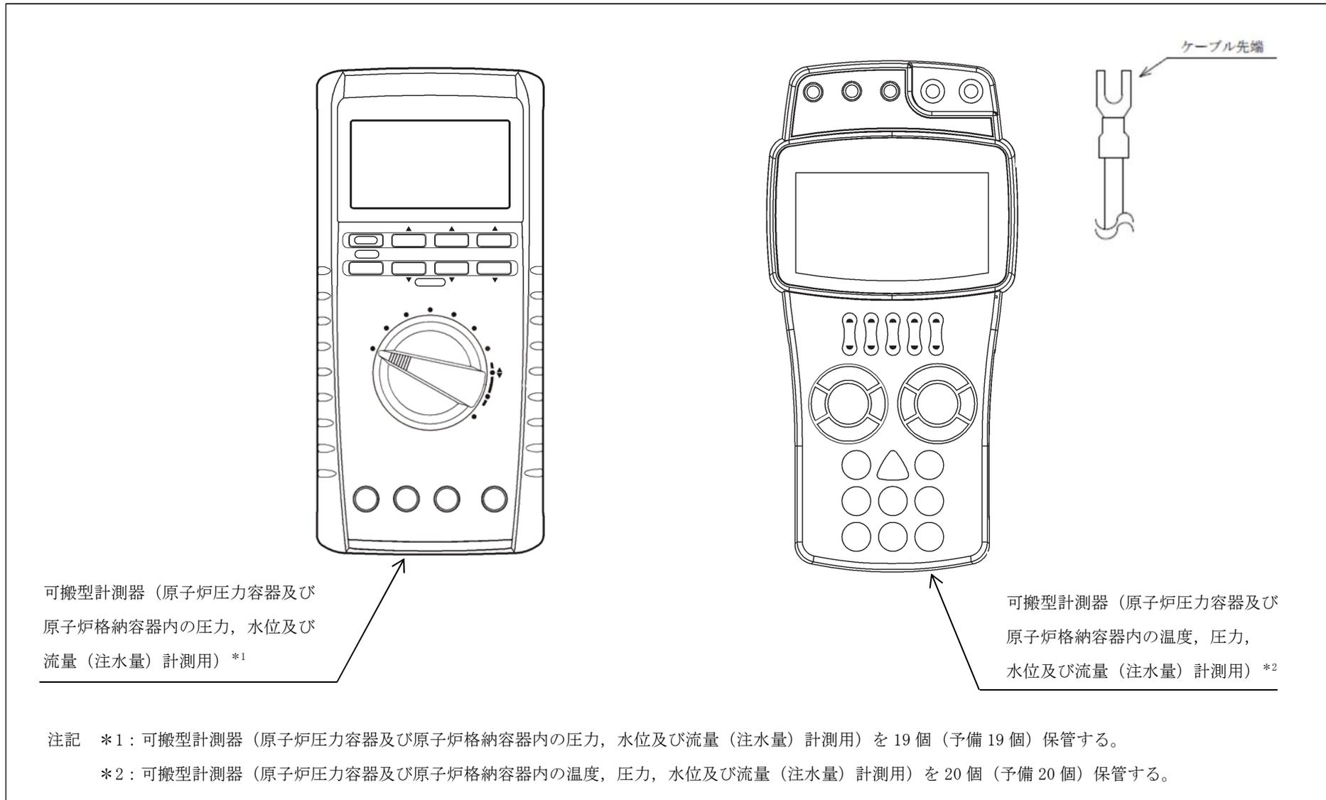
図 3-1-9-30 検出器の構造図（可搬型計測器）
