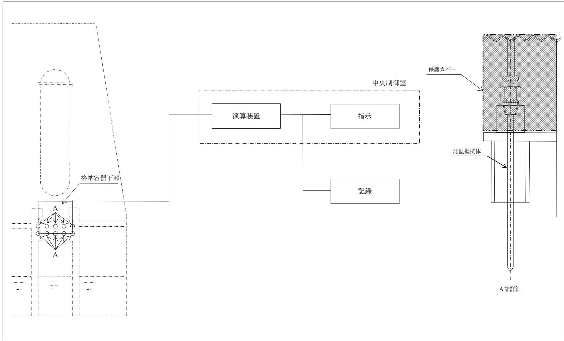
図 3-1-4-15 検出器の構造図 (格納容器下部水温)
