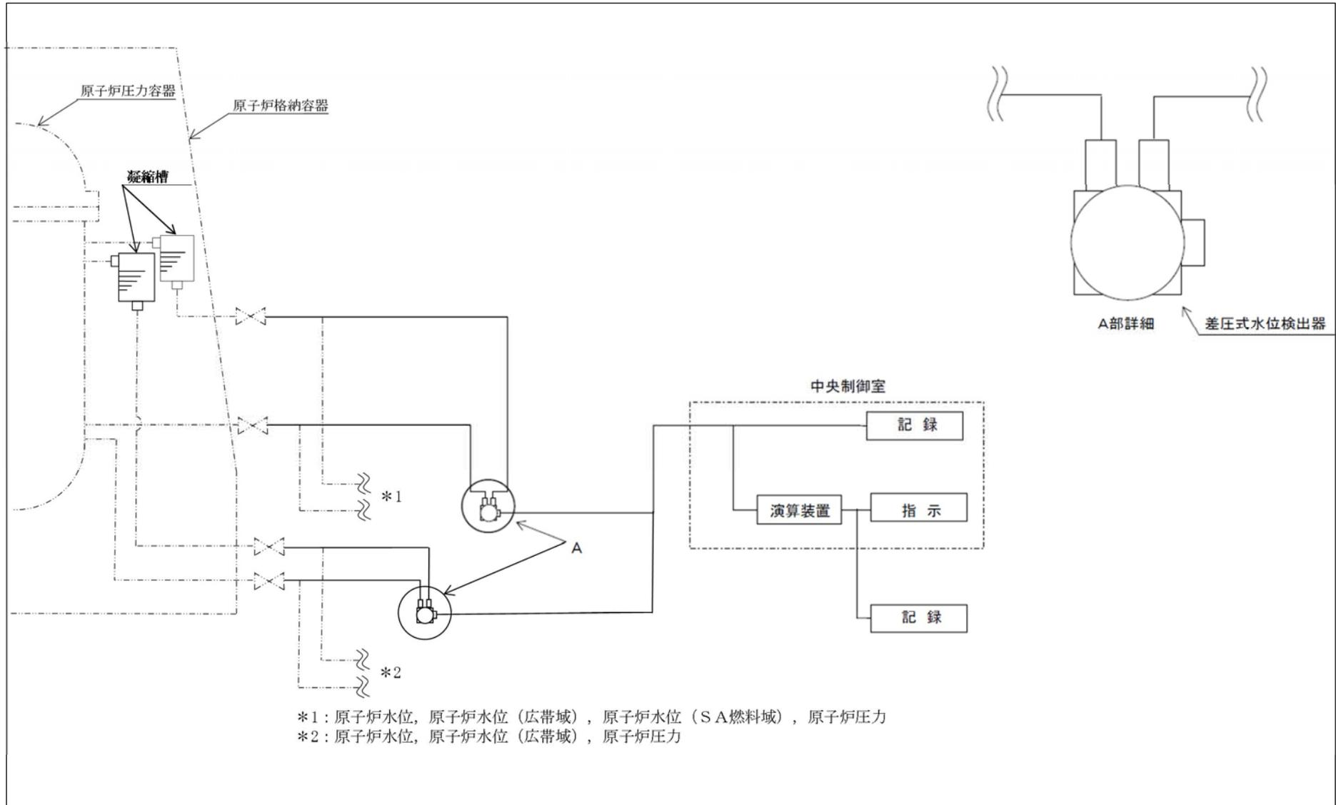
図 3-1-3-8 検出器の構造図 (原子炉水位 (燃料域))
