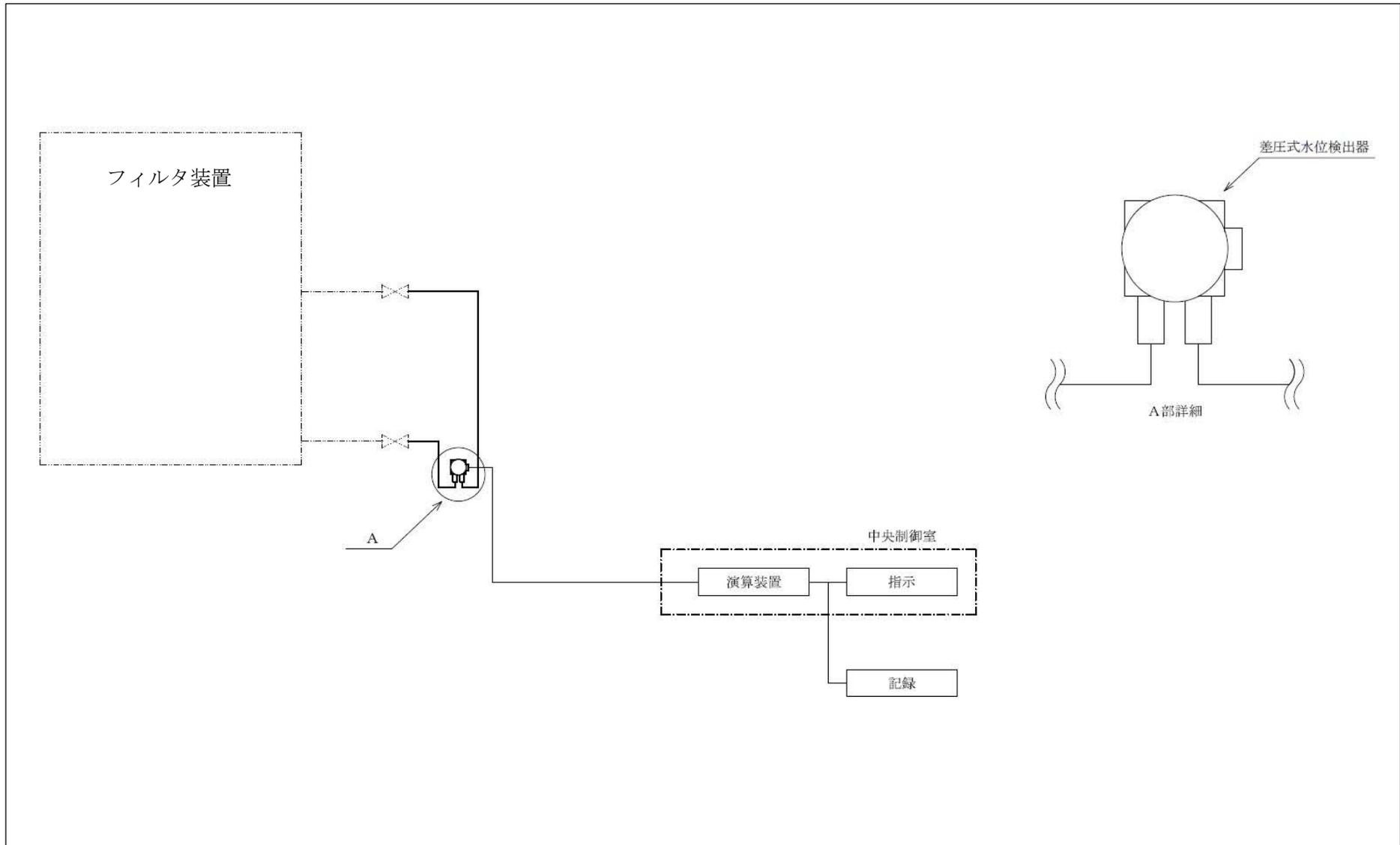
図 3-1-9-4 検出器の構造図 (フィルタ装置水位)
