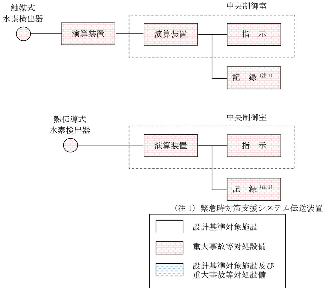
図 3-1-8-1 原子炉建屋水素濃度の概略構成図
