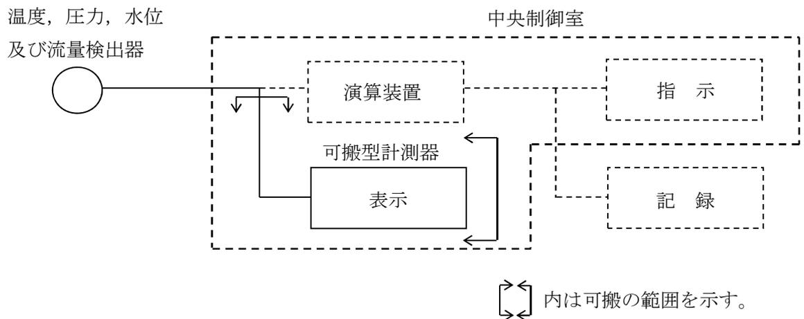
図 3-1-9-29 可搬型計測器の概略構成図
