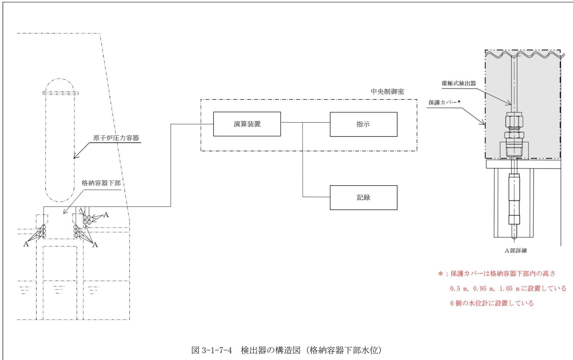
図 3-1-7-4 検出器の構造図 (格納容器下部水位)
