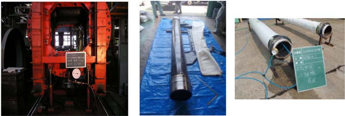
第1-26図 止水ゴム等の耐圧試験例
