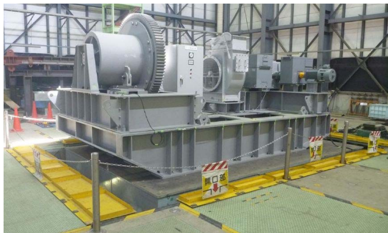
第9図 開閉装置の試験装置（全景）
