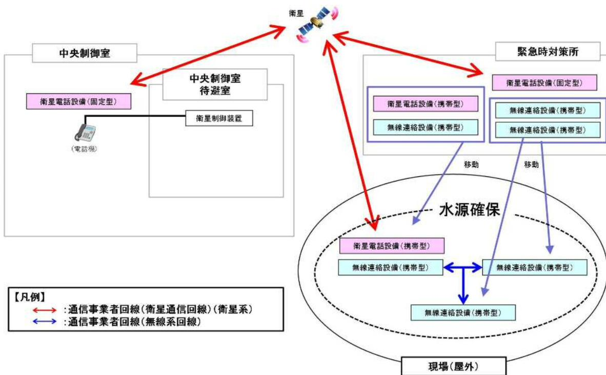
図 1 9 衛星電話設備（固定型）等を用いた通信連絡の概要
