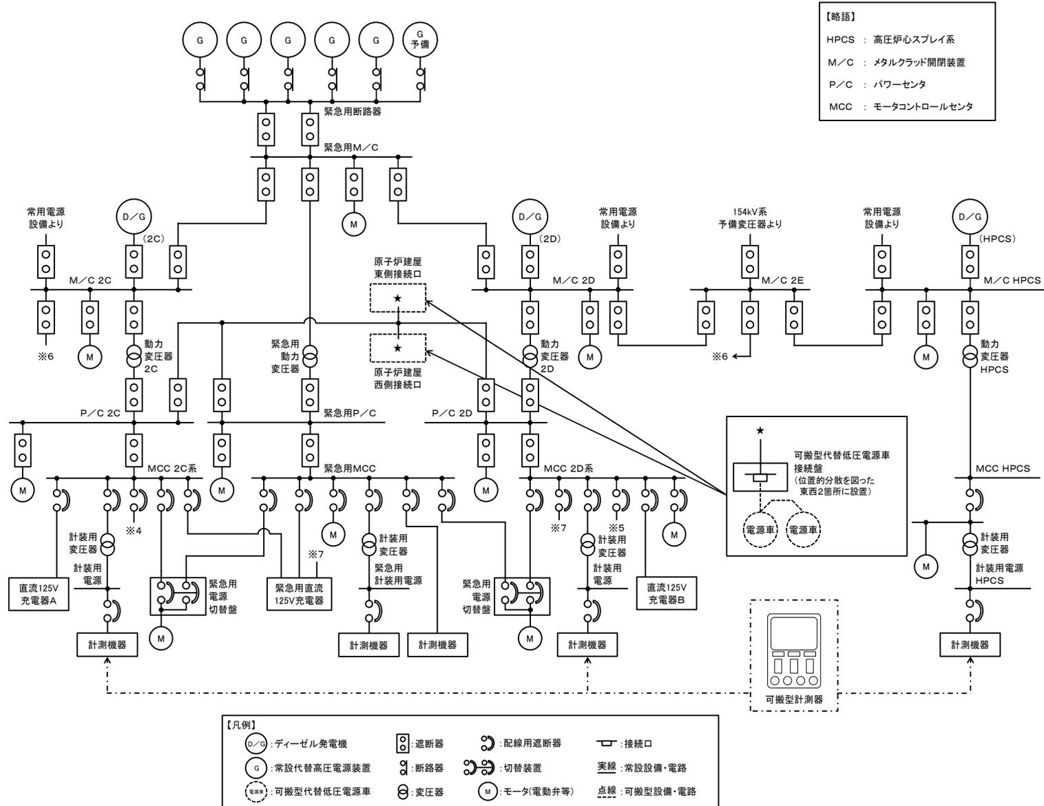
第 1.15-4 図 計器の電源構成図 (交流電源) (3/3)
