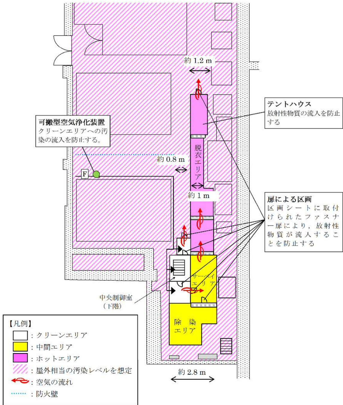
第 11 図 中央制御室チェン징エリアの空気の流れ
