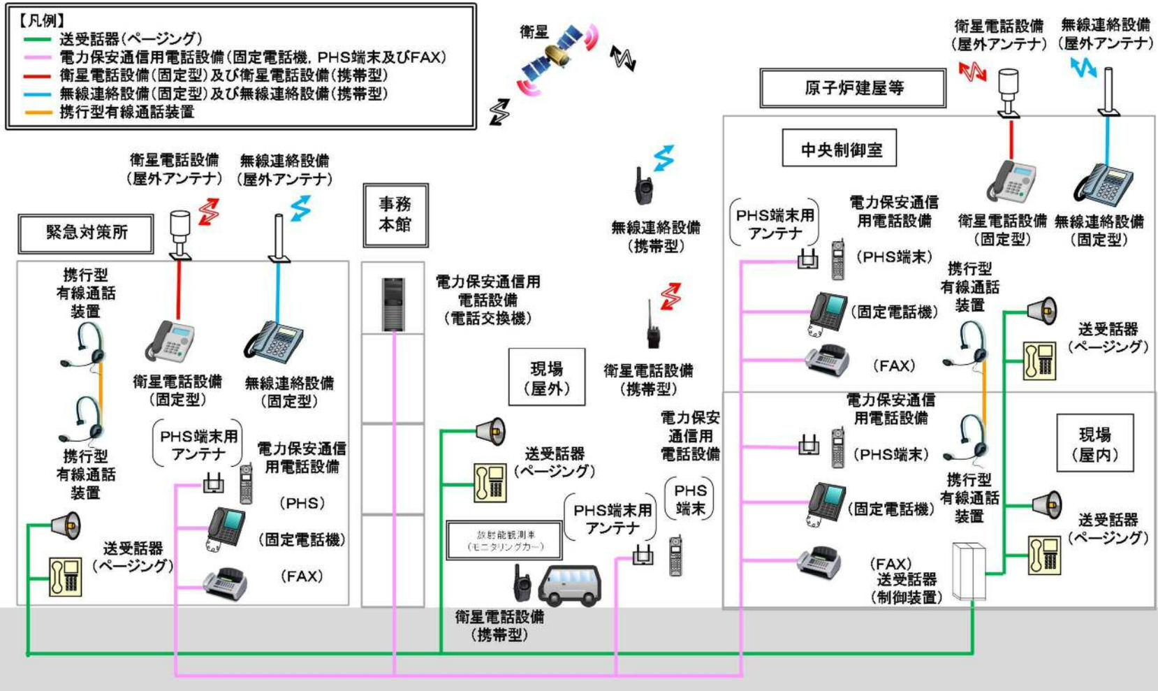
図2 通信設備(発電所内)の概要
