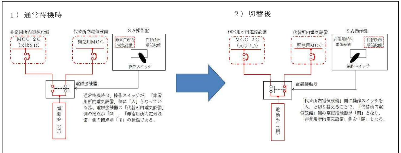
図 1 緊急用電源切替盤操作方法
