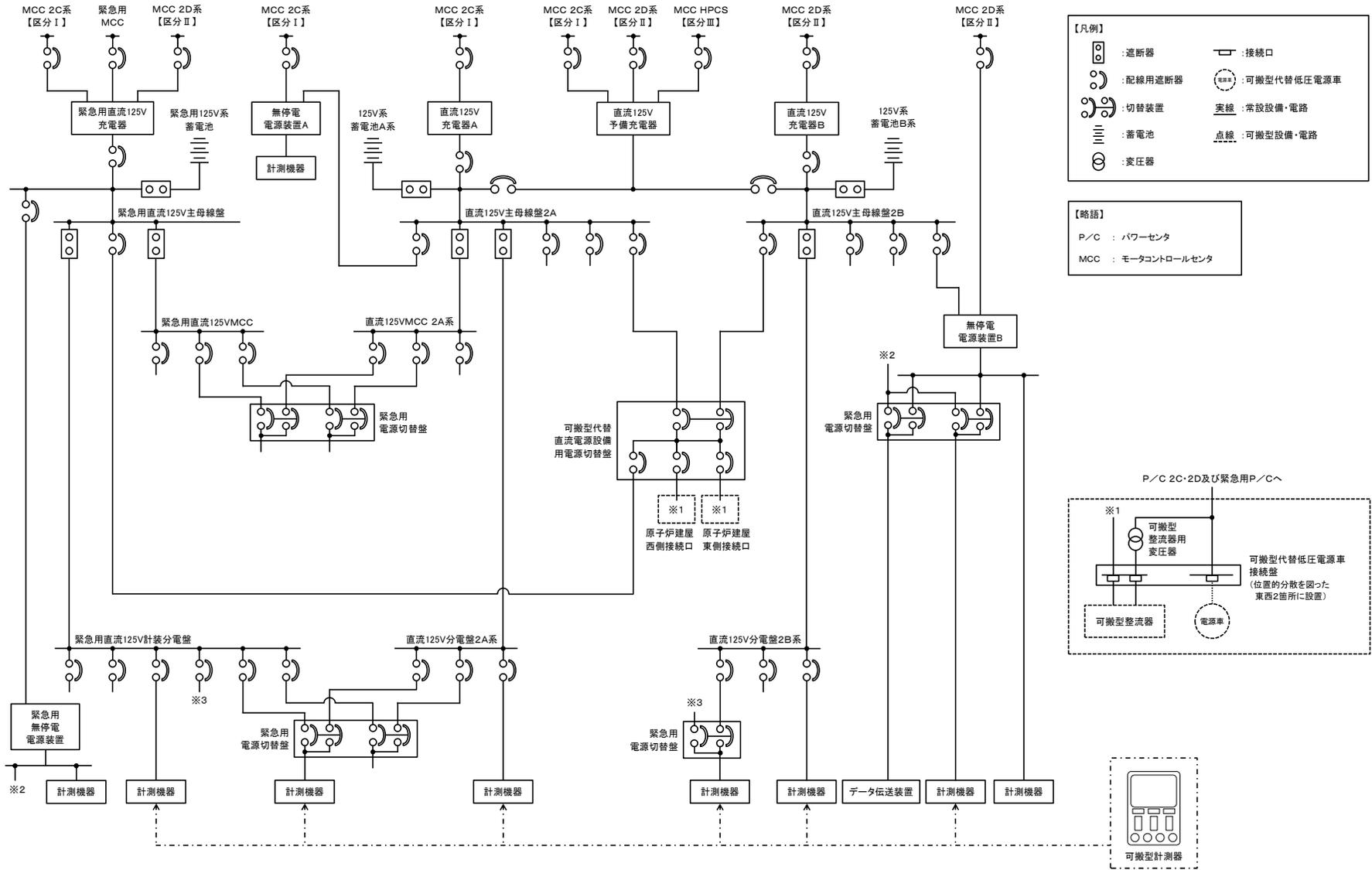
第 1.15-4 図 計器の電源構成図 (直流電源) (1/3)
