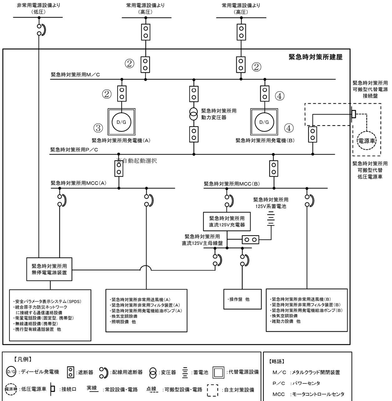
※○数字は、緊急時対策所用発電機（A）を自動起動とし、緊急時対策所用発電機（B）を手動起動する場合の給電手順にて、操作する遮断器及び機器を示す。
