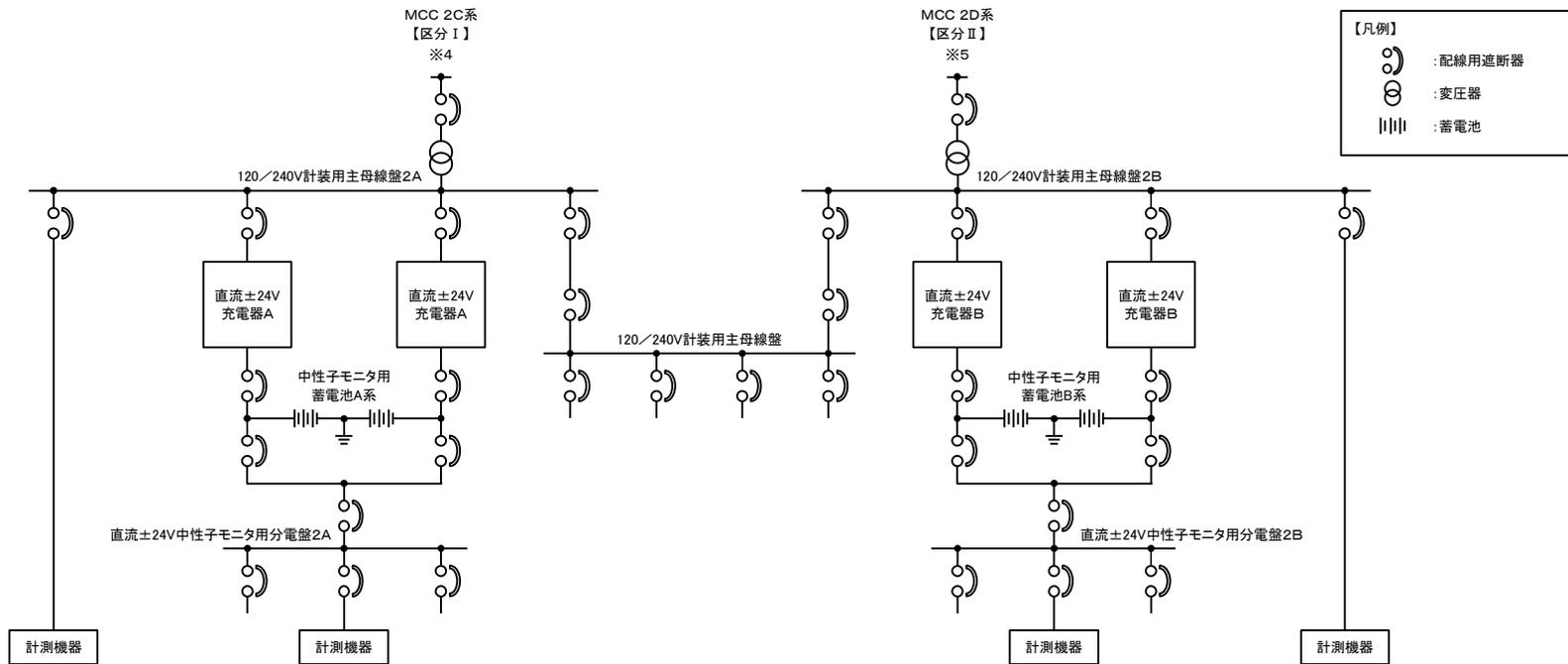
第 1.15-4 図 計器の電源構成図 (直流電源) (2/3)
