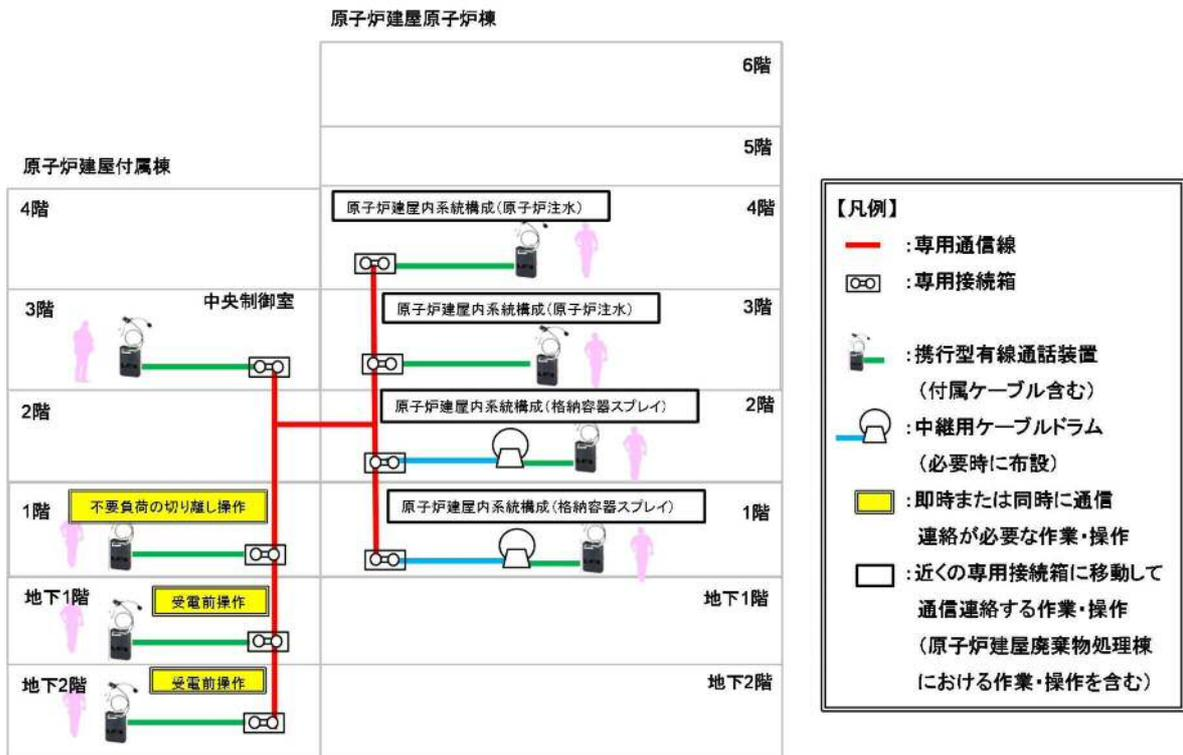
図 1 5 携行型有線通話装置を用いた通信連絡の概要
