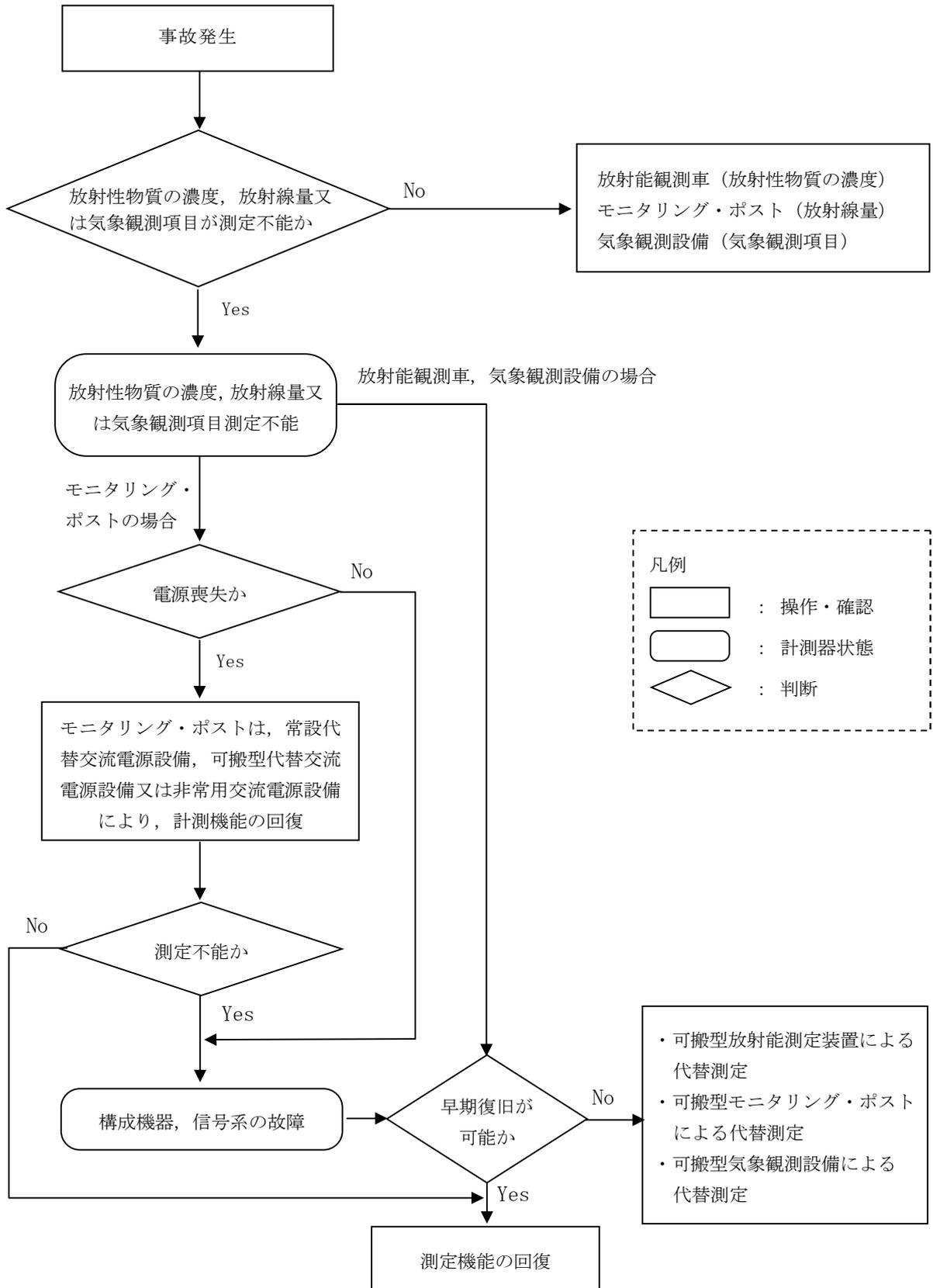
第 1.17-1 図 放射性物質の濃度、放射線量及び気象観測項目の測定不能時対応手順
