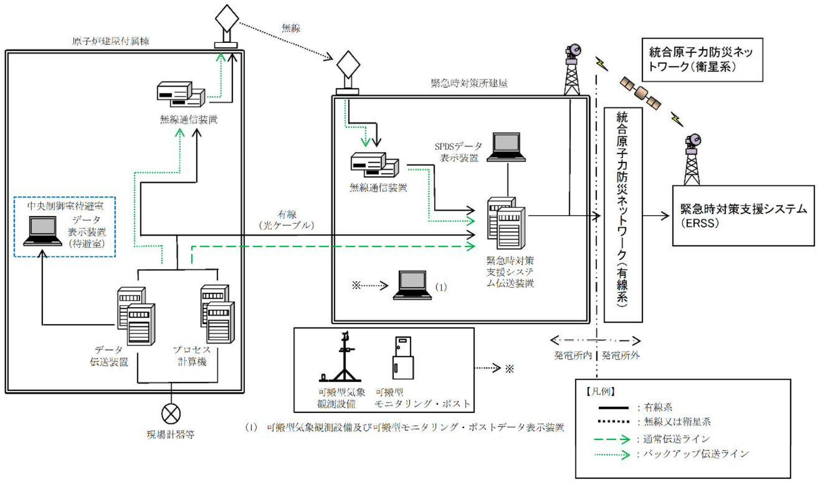
図6 SPDS及びデータ伝送設備の概要
