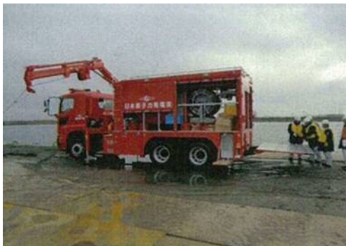
可搬型代替注水中型ポンプ
