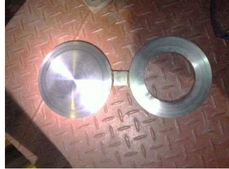
連絡配管閉止フランジ
