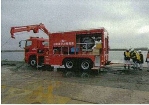
可搬型代替注水中型ポンプ
