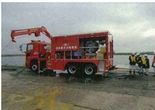
可搬型代替注水中型ポンプ
