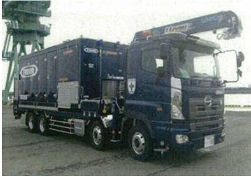
可搬型代替注水大型ポンプ
