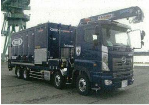
可搬型代替注水大型ポンプ
