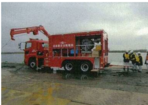
可搬型代替注水中型ポンプ
