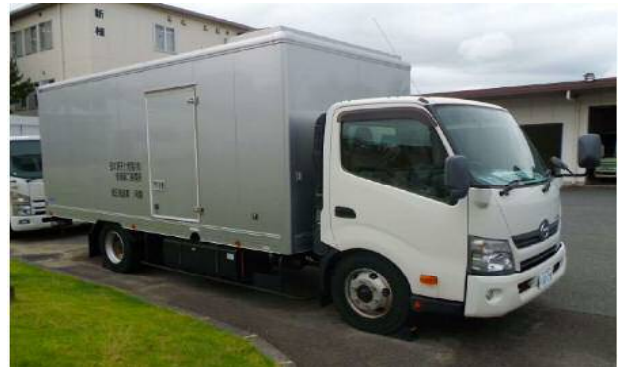
可搬型代替低圧電源車
