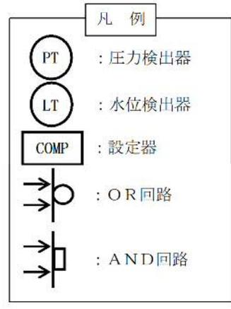
第1図 誤動作率評価モデル (その1)
