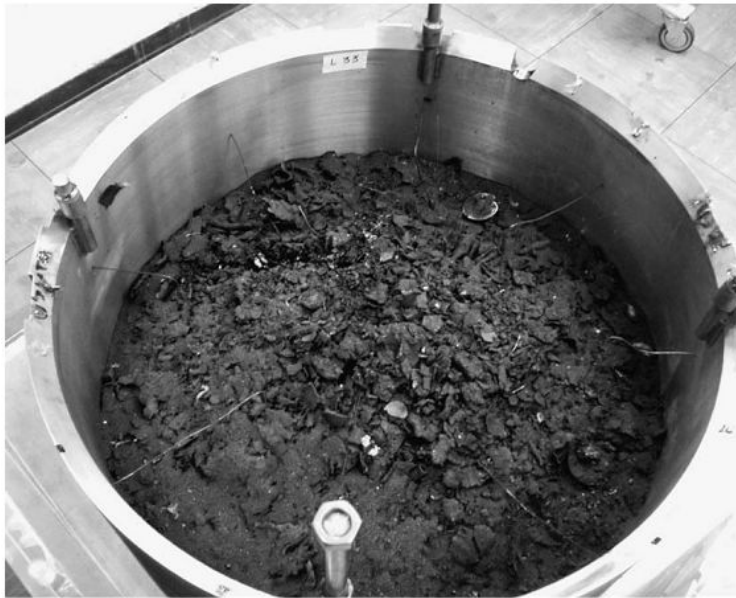
付図 3-2 FARO L-24 実験後のデブリの堆積状態 (数値単位 mm) [14]
