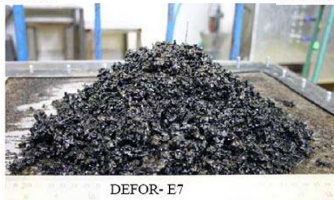
付図 3-6 DEFOR-E 実験後のデブリ状態 [16]
