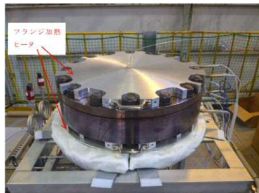
試験装置外観（フランジ密閉時）
