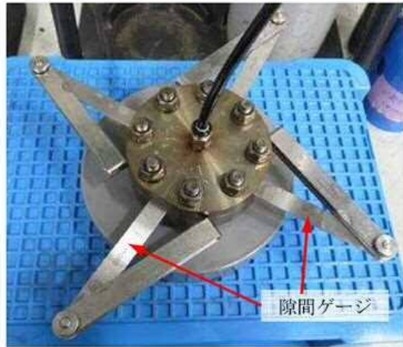
第6図 開口模擬したHe気密試験 (隙間ゲージ使用)
