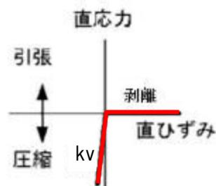
図6 杭下端ジョイントばねの考え方
