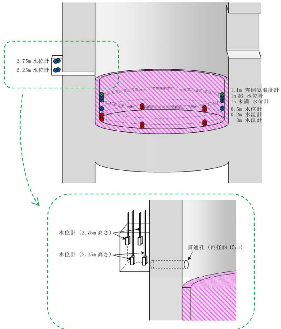
図 2-1 格納容器下部内の計器設置図
