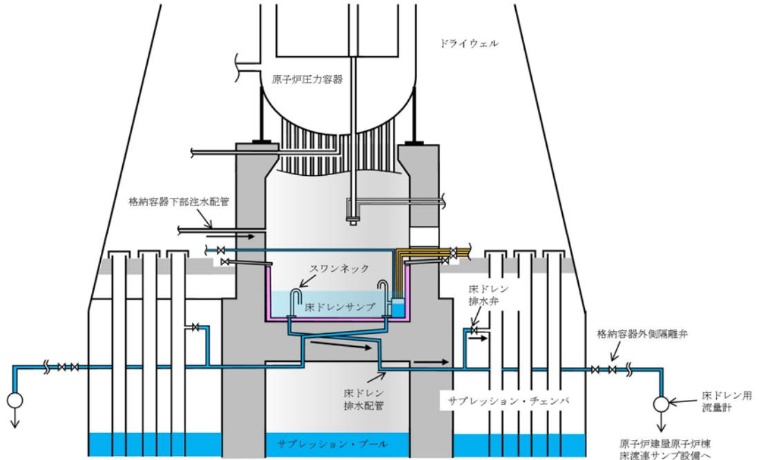
図 2-6 格納容器下部の概要
