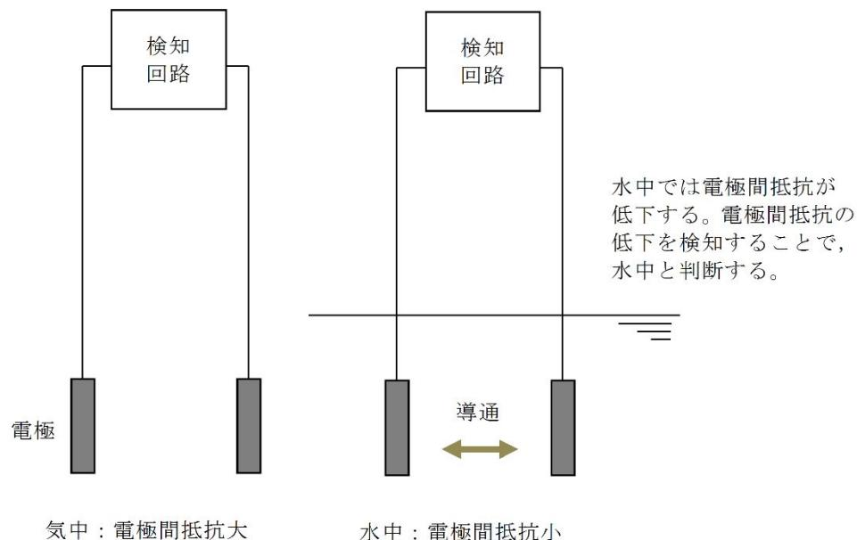
図 2-2 電極式水位計の動作原理
