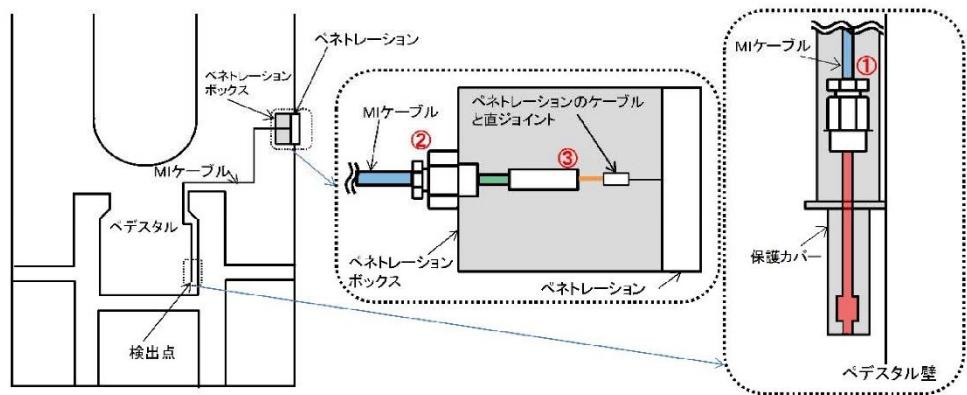
格納容器下部水位計の設置概略図
