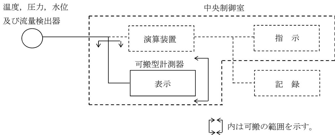
図 4-1 可搬型計測器の概略構成図
