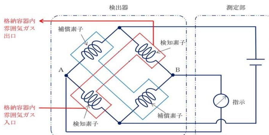
図 1-2-1-1 格納容器内水素濃度 (S A) 検出回路の概要図
