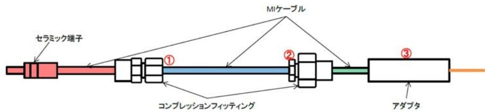
格納容器下部水位計（電極式）構造図
