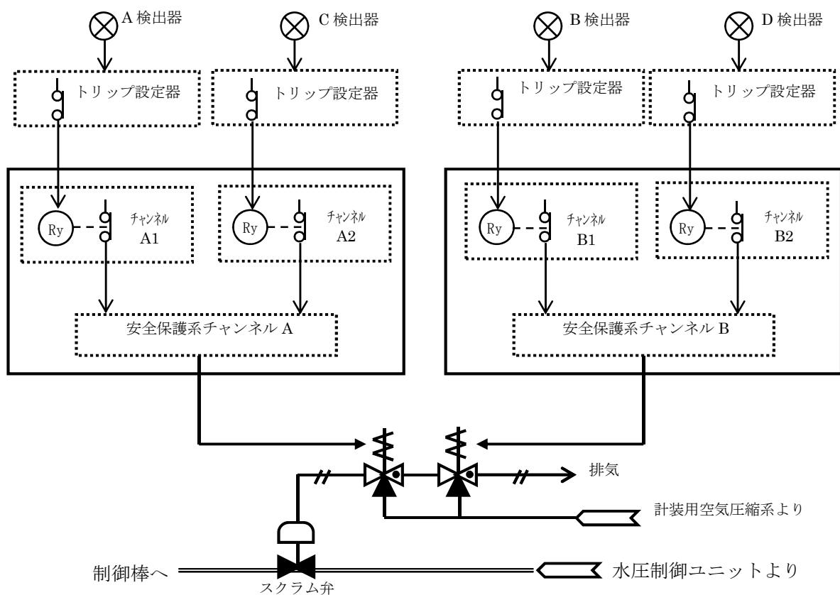
図 6-1-1 原子炉緊急停止系の構成例
