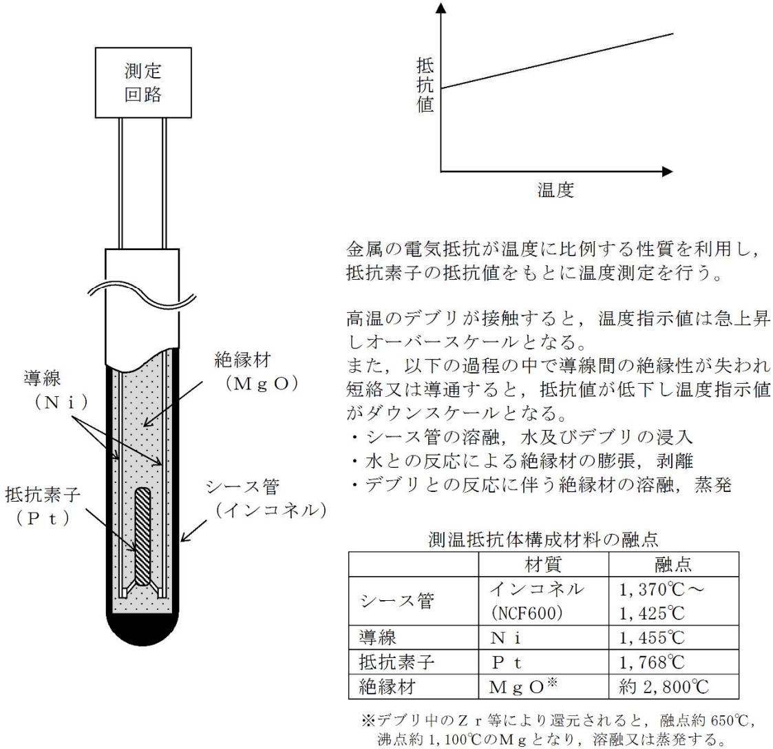
図 2-3 測温抵抗体式温度計の動作原理
