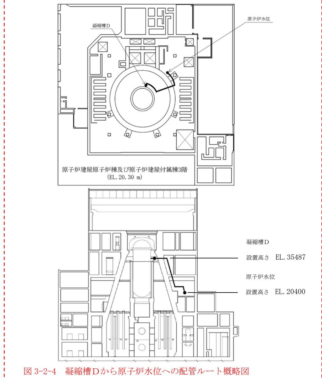
図 3-2-4 凝縮槽Dから原子炉水位への配管ルート概略図
