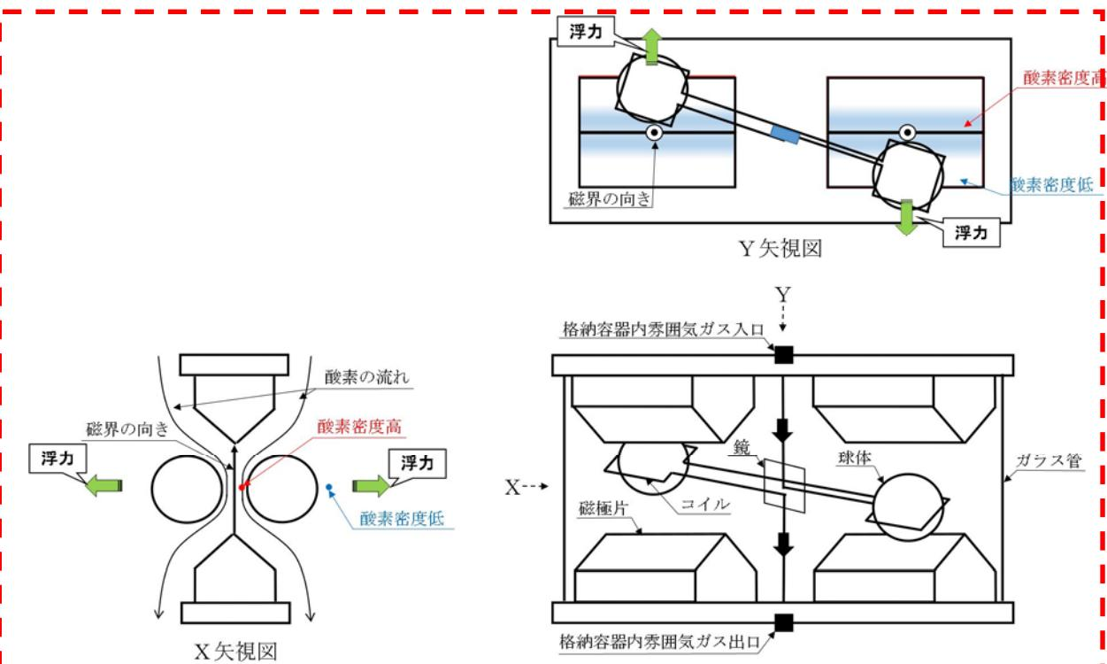
図 1-2-2-1 格納容器内酸素濃度（S A）の概要図
