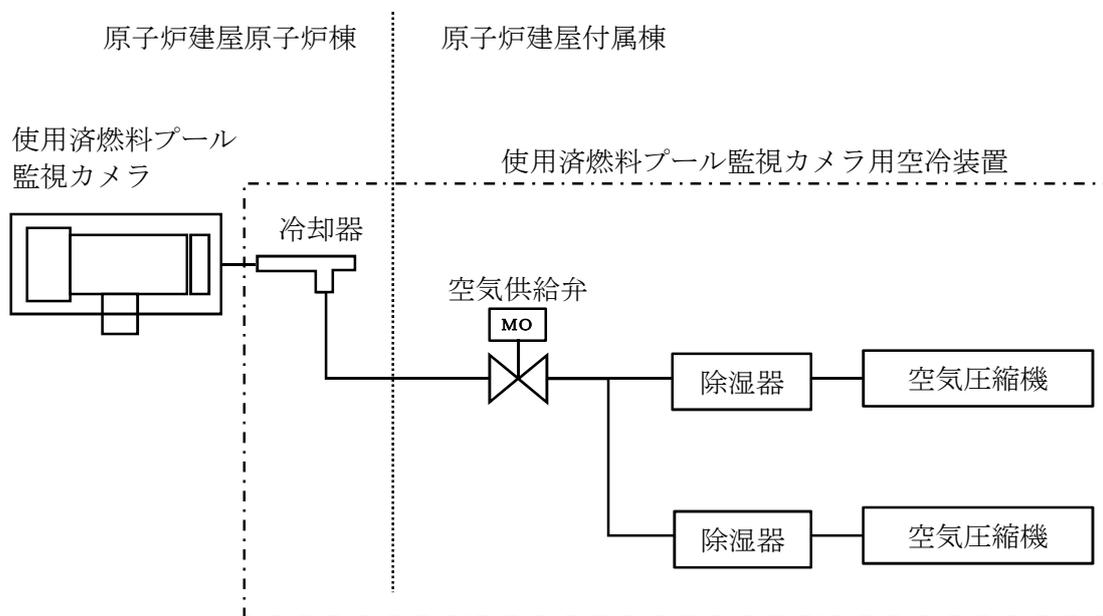
第 2-4-1 図 使用済燃料プール監視カメラ用空冷装置の概略構成図
