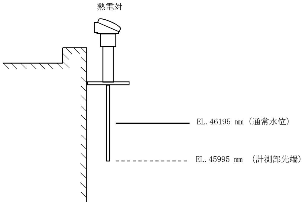
図 1-1-1 使用済燃料プール温度の設置図
