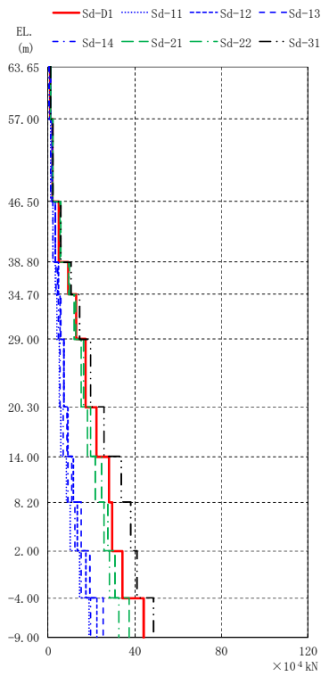
図 4-20 最大応答せん断力 ( S_d , NS 方向)
