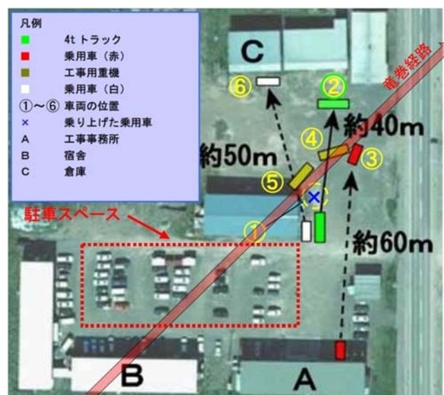
図 6-2 佐呂間竜巻による被災状況（工事事務所敷地内の車両被災） （文献 (27) の写真に竜巻被害の方向を加筆）
