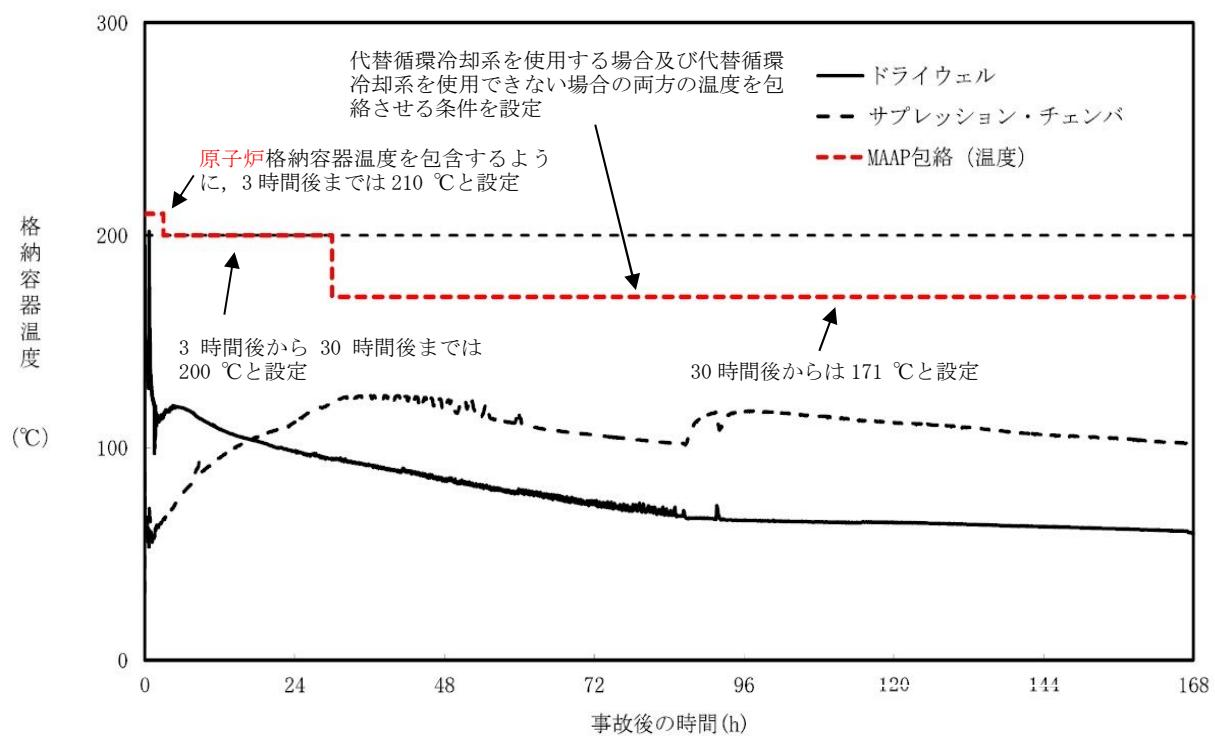
第 2.3.1-4 図 格納容器温度（有効性評価シナリオ包絡条件）
