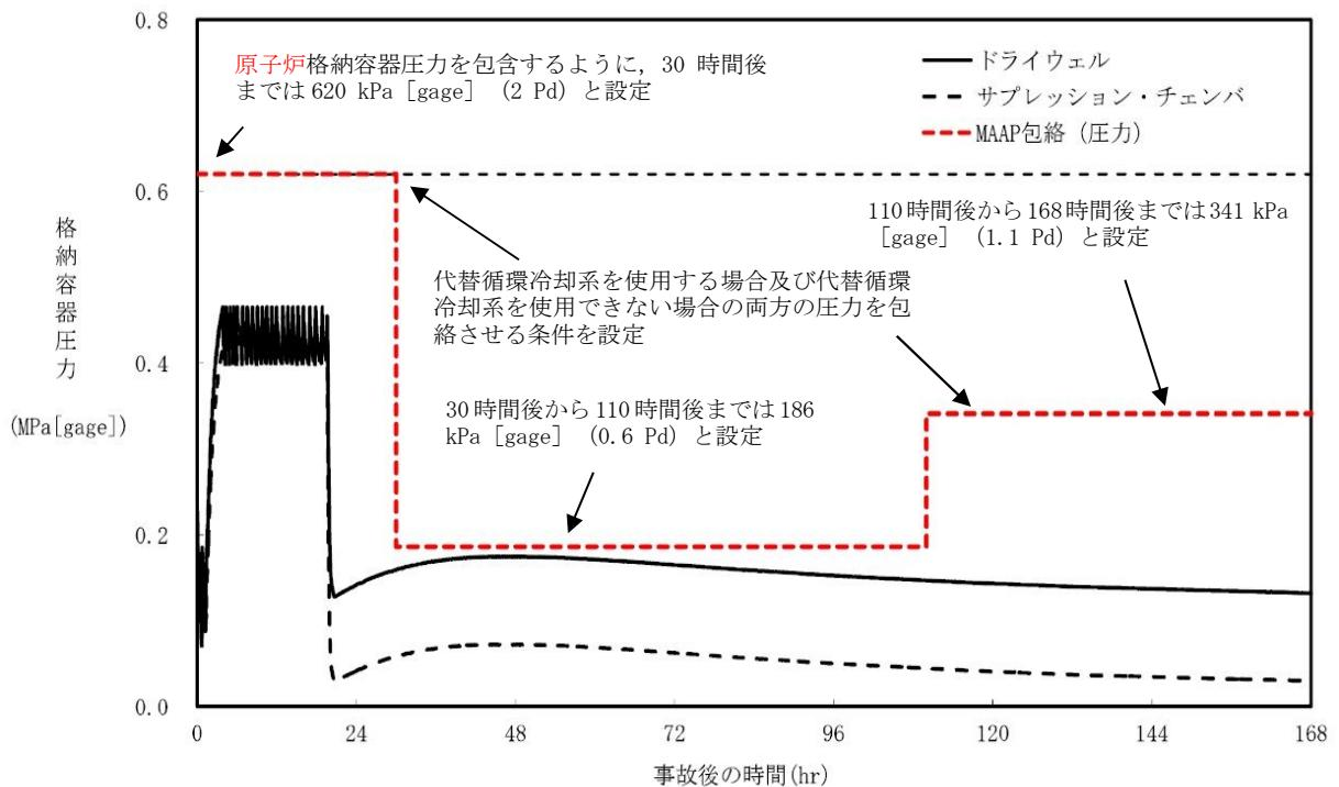
第 2.3.1-3 図 格納容器圧力（有効性評価シナリオ包絡条件）
