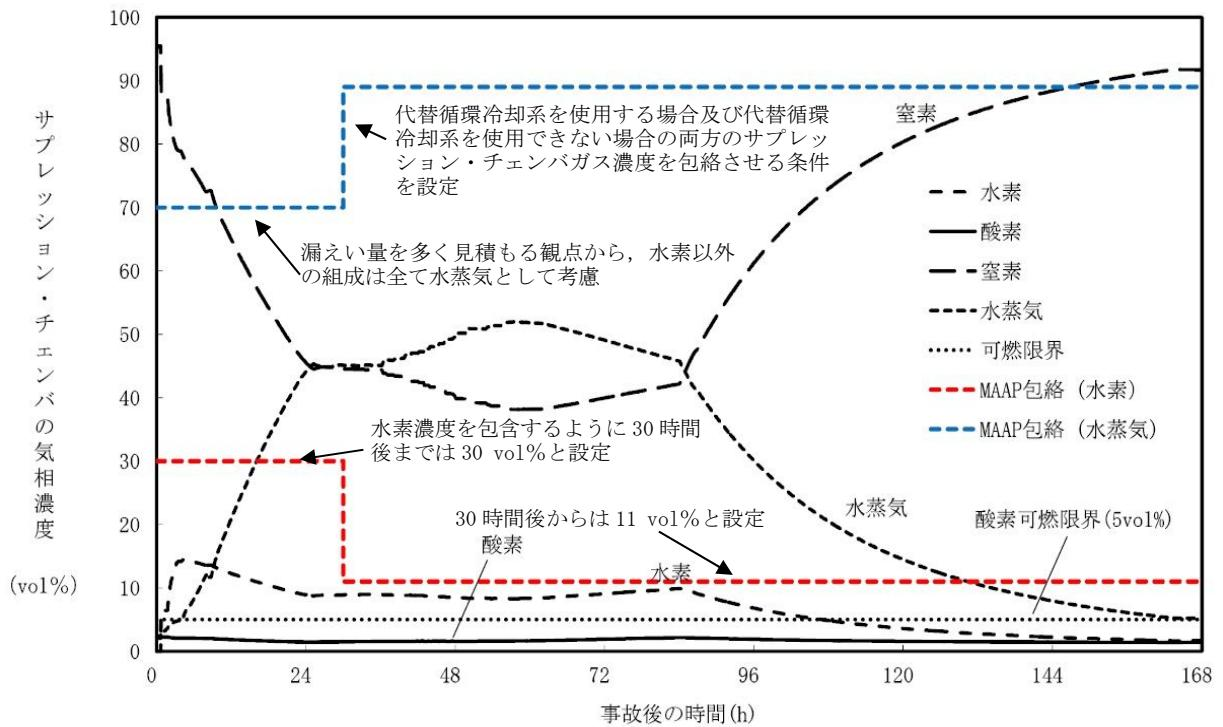
第 2.3.1-8 図 サプレッション・チェンバガス濃度（有効性評価シナリオ包絡条件）
