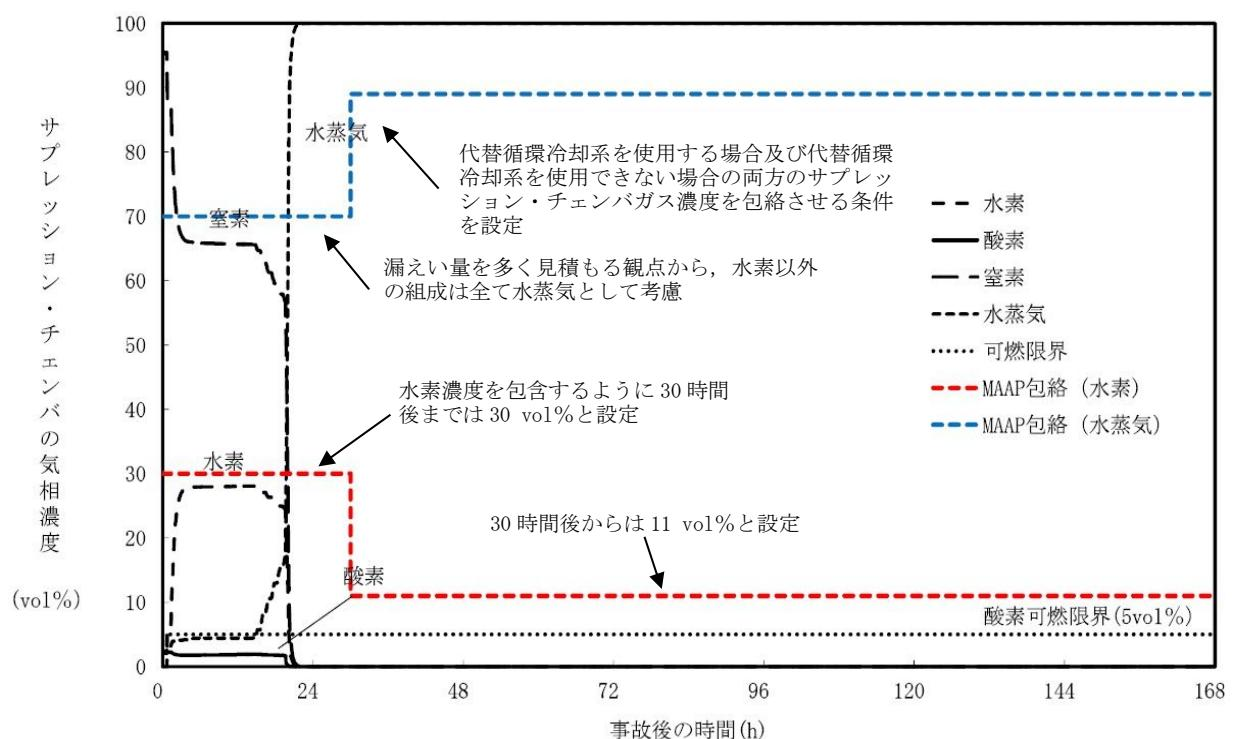
第 2.3.1-9 図 サプレッション・チェンバ組成（有効性評価シナリオ包絡条件）
