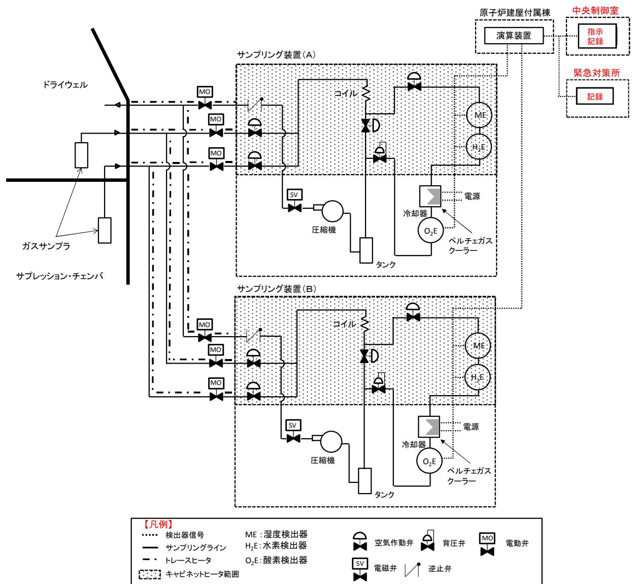
第2-4図 格納容器内水素濃度（S A）及び格納容器内酸素濃度（S A）系統概要図
