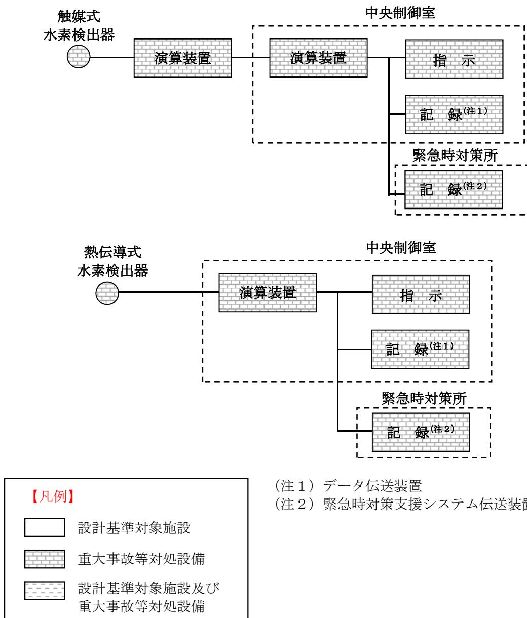
第2.4-4図 原子炉建屋水素濃度の概略構成図
