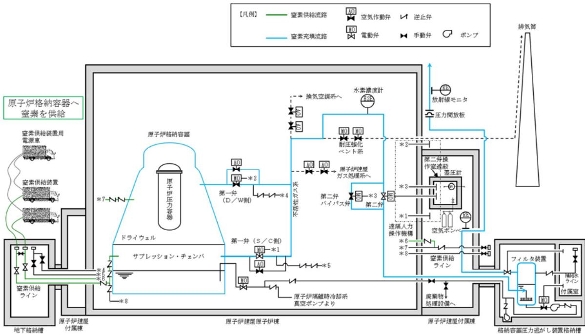
第2-2図 窒素供給装置の系統概略図
