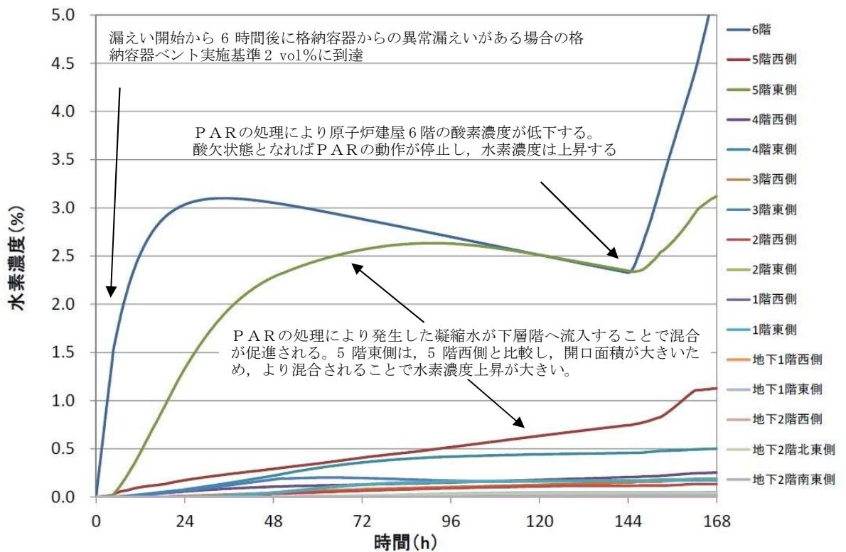
第 2.3.2-3 図 ケース 2 水素濃度の時間変化（原子炉建屋原子炉棟全域）
