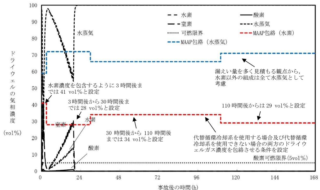
第 2.3.1-7 図 ドライウェルガス濃度（有効性評価シナリオ包絡条件）
