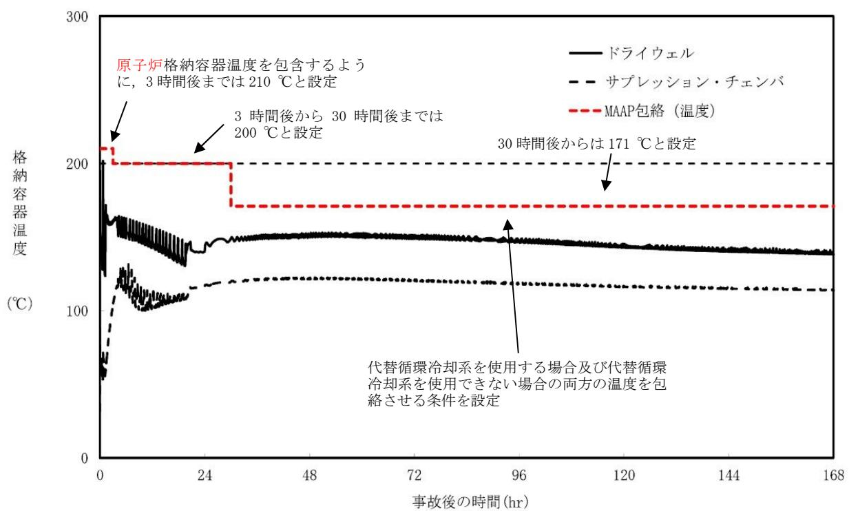
第 2.3.1-5 図 格納容器温度（有効性評価シナリオ包絡条件）
