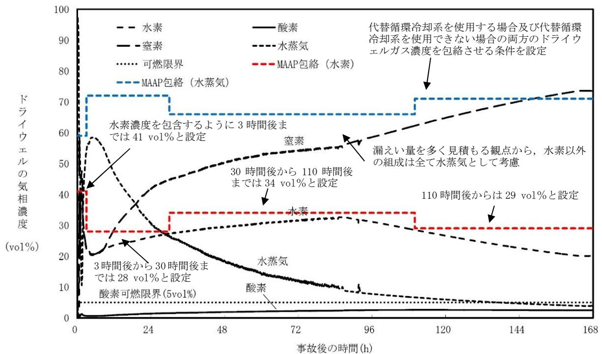
第 2.3.1-6 図 ドライウェルガス濃度（有効性評価シナリオ包絡条件）
