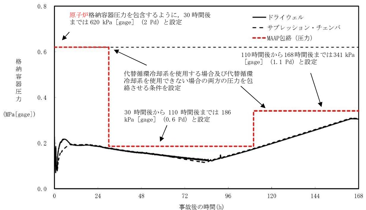
第 2.3.1-2 図 格納容器圧力（有効性評価シナリオ包絡条件）
