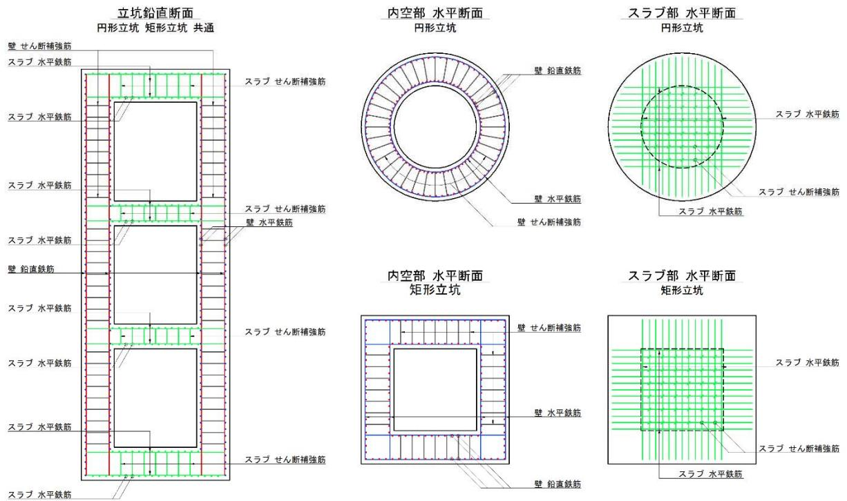
図 2-3 各部材評価で照査対象とする鉄筋
