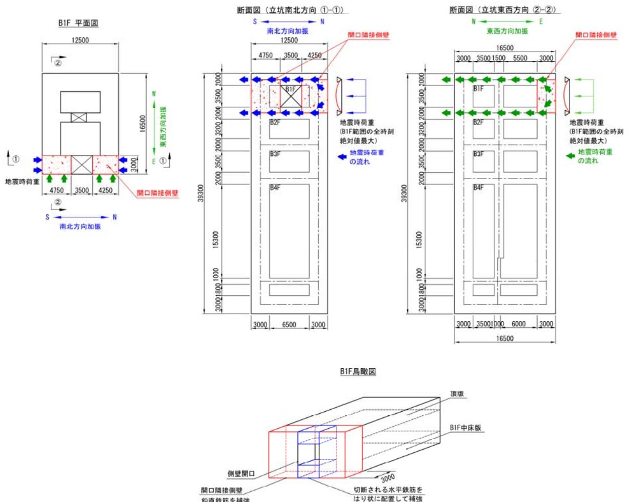
図 7-1 側壁開口部概念図
