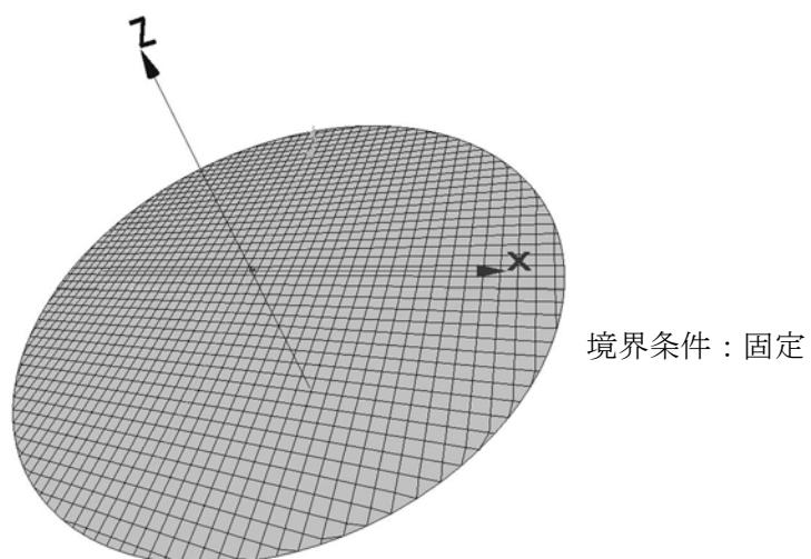
図 9-4 底版部の端モーメント算出モデル (シェル解析)
