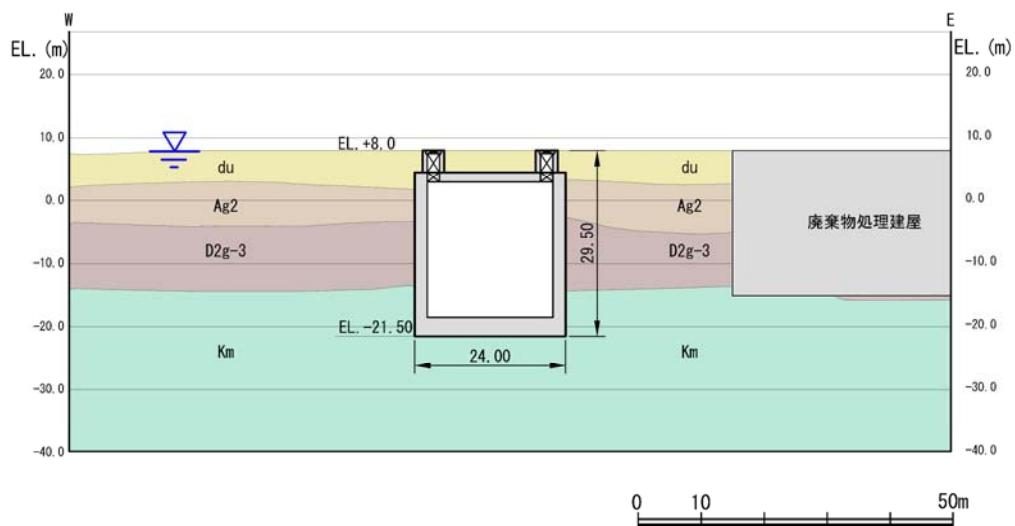
図 1-3 (2) 代替淡水貯槽地質断面図 (A-A断面)
