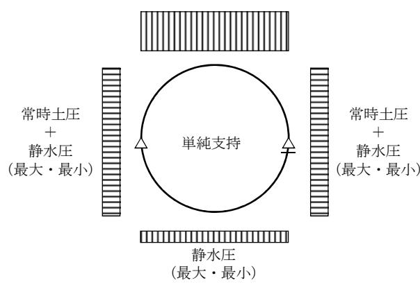
常時土圧 + 静水圧 + 地震時最大地盤反力
