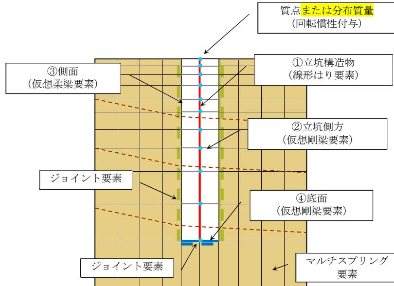
図 3-3 立坑構造物の解析モデル概念図
