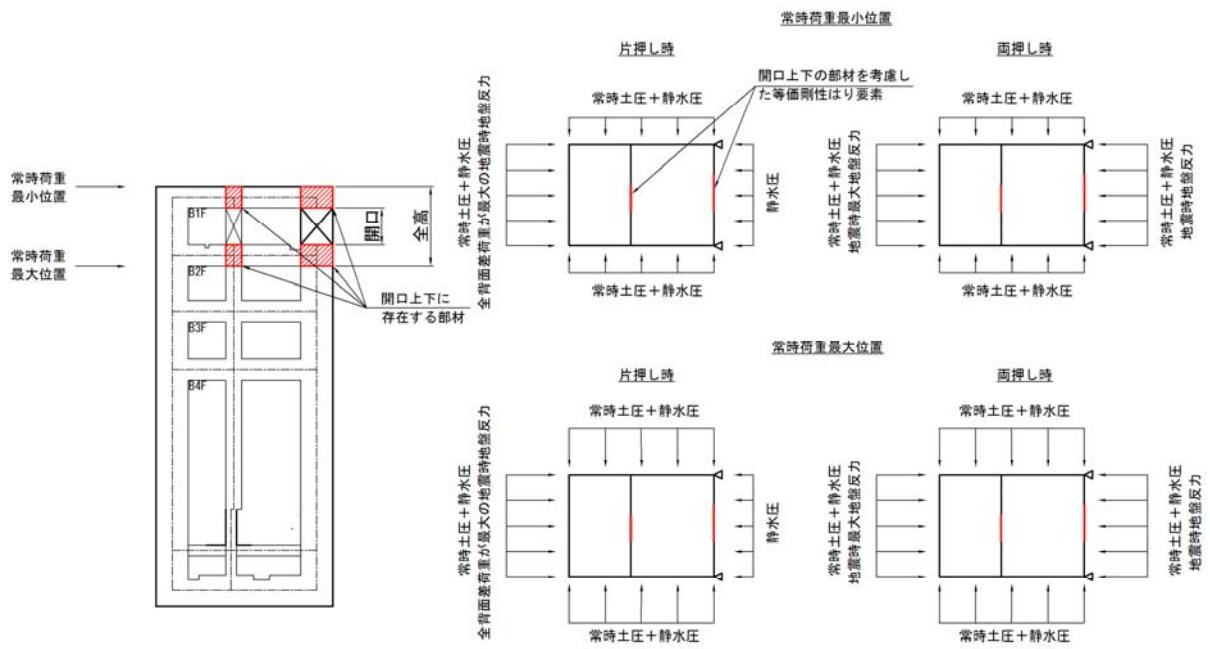
図 5-4 水平面解析モデル概念図（開口部を含む構造部）
