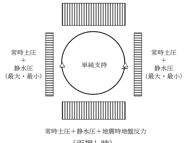
図 5-1 凹形立坑の水平断面解析モデル概念図
