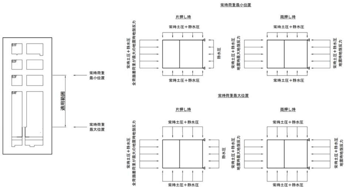
図 5-2 水平面解析モデル概念図（開口部がない構造部）
