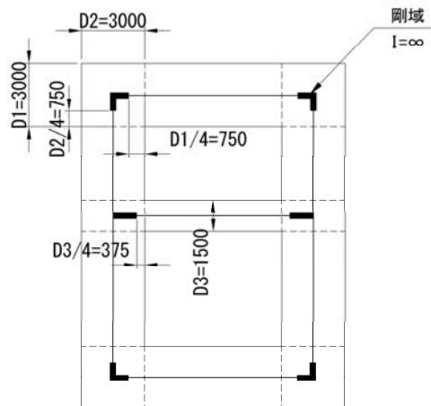
図 5-3 水平面フレーム解析における剛域の考え方
