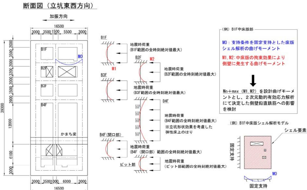
図 9-1 版部材から側壁に廻り込む曲げモーメント算定概念図
