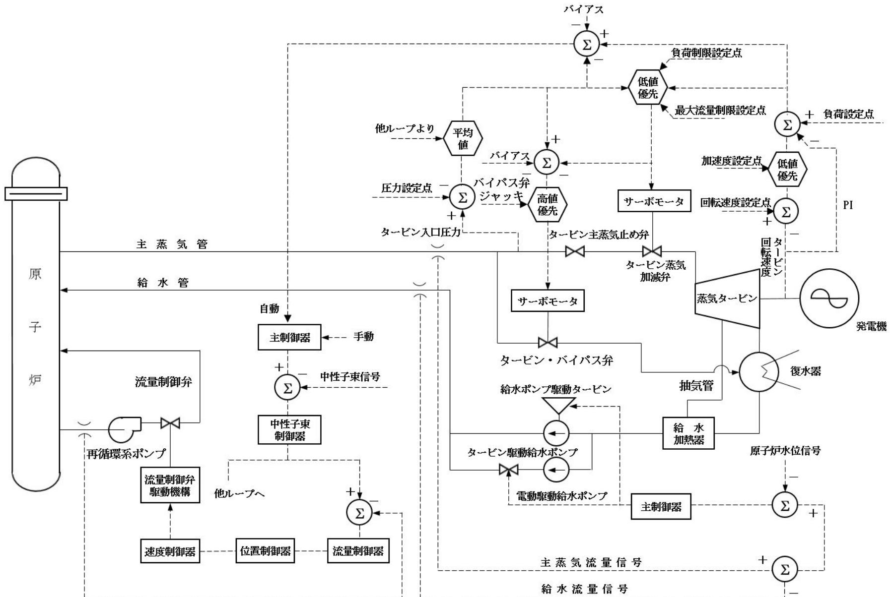
第3-1図 発電用原子炉の出力制御設備
