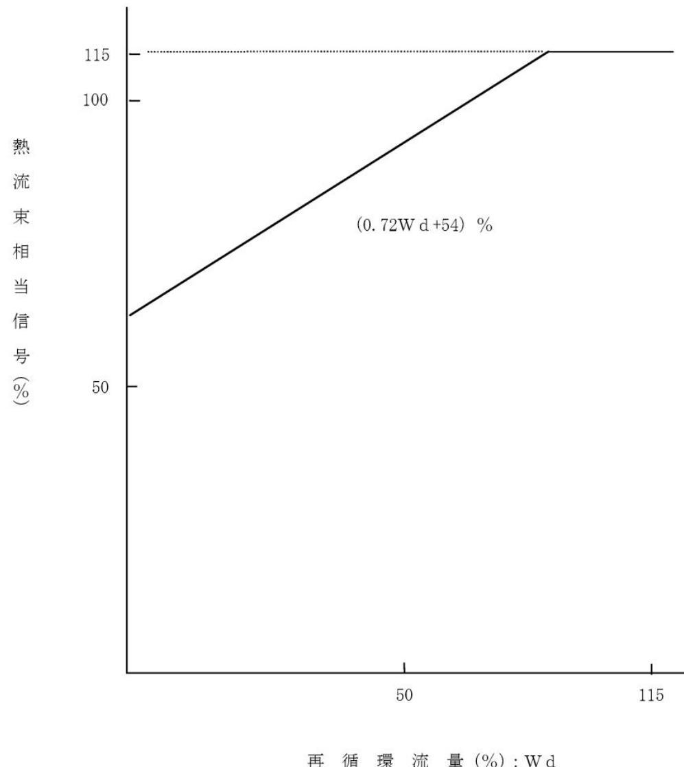
第3-4-4-1図 中性子束高一自動可変設定（熱流束相当）の原子炉非常停止信号の設定値
