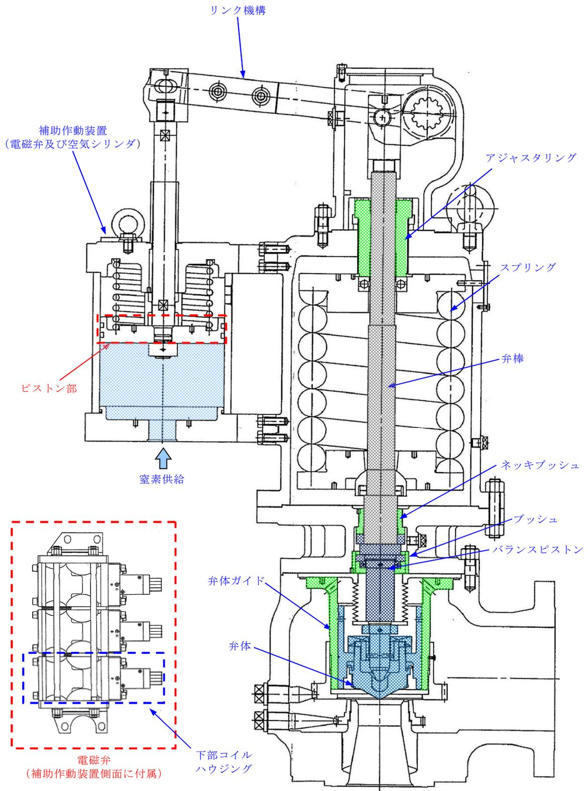
第1図 SRV構造図 (開状態)
