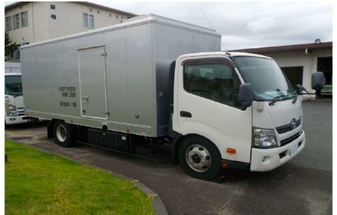
可搬型代替低圧電源車
