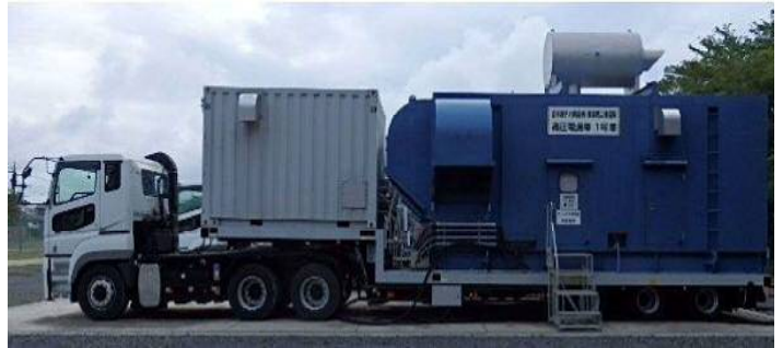
常設代替交流電源装置
