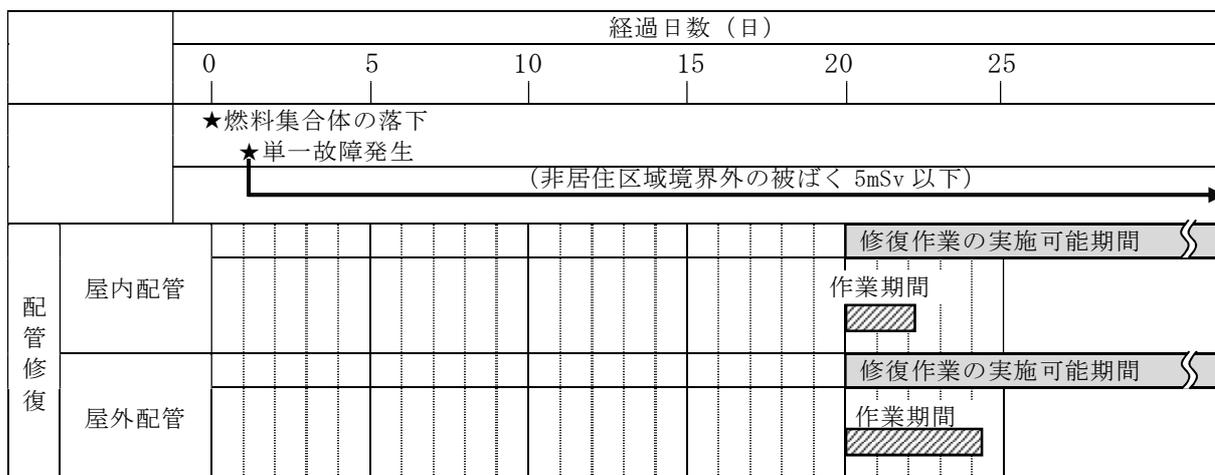
なお、設定した作業期間は原子炉建屋ガス処理系の機能を回復させるための最短の時期を示しており、実運用における作業期間は公衆や作業員の被ばくを考慮した上で決定する。なお、作業期間におけるタイムチャートについては「(3)詳細工程について」で示す。
