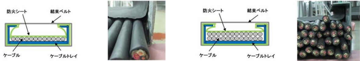
a. ケーブル少量時の施工断面
