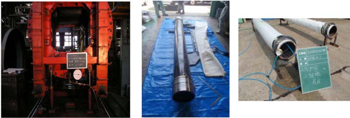
第1-26図 止水ゴム等の耐圧試験例
