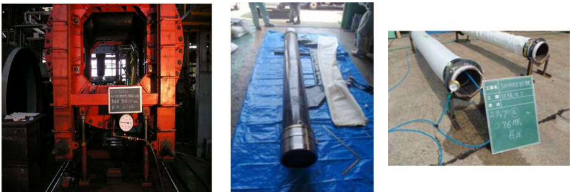
第 13 図 止水ゴム等の耐圧試験例
